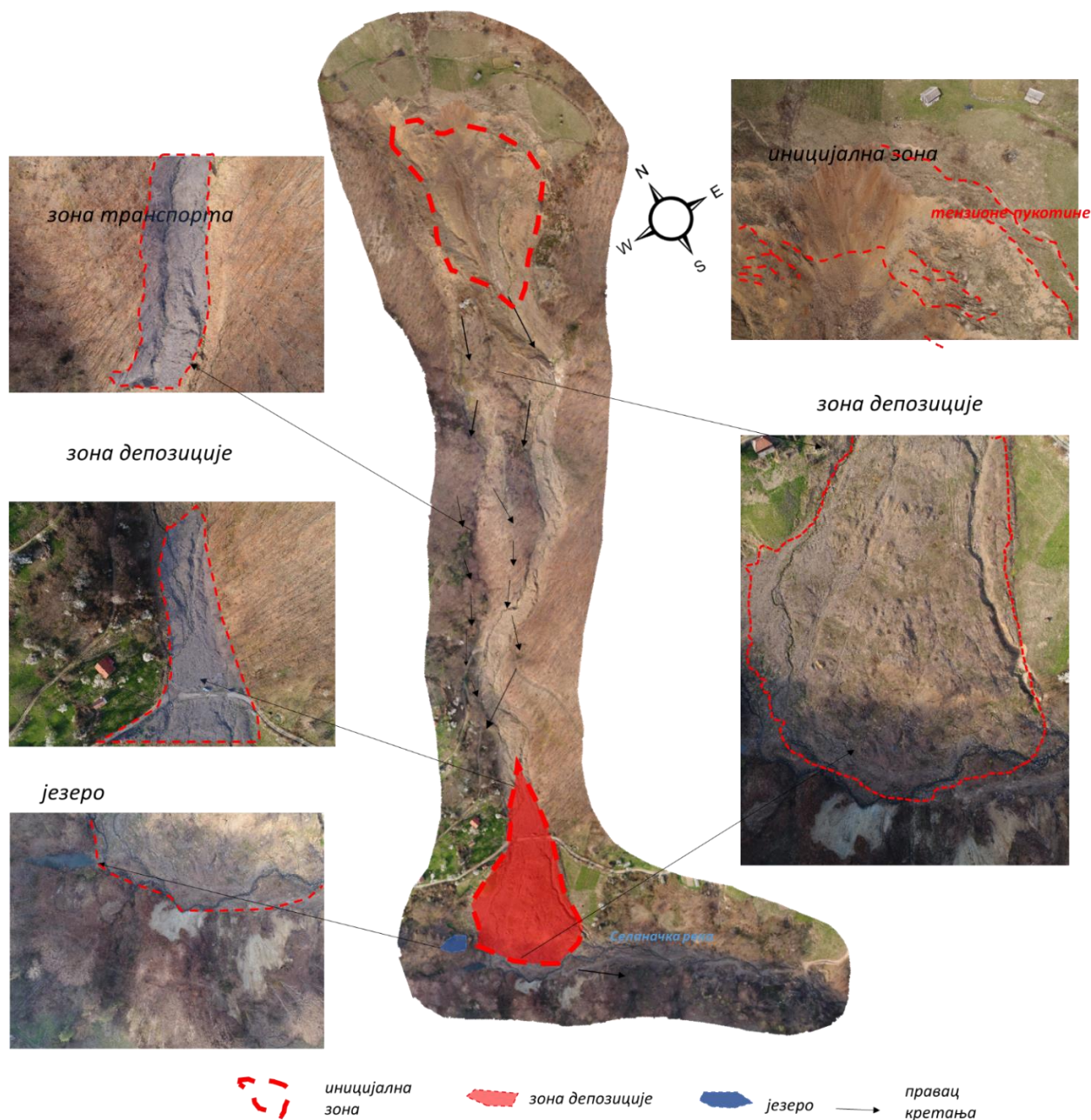
Слика 6.1 Ортофото снимак тецишта Селанац добијен UAV фотограметријским снимањем са карактеризацијом основних геометријских елемената
