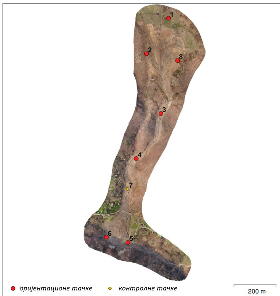
Слика 6.7 Положај оријентационих и контролних тачака
