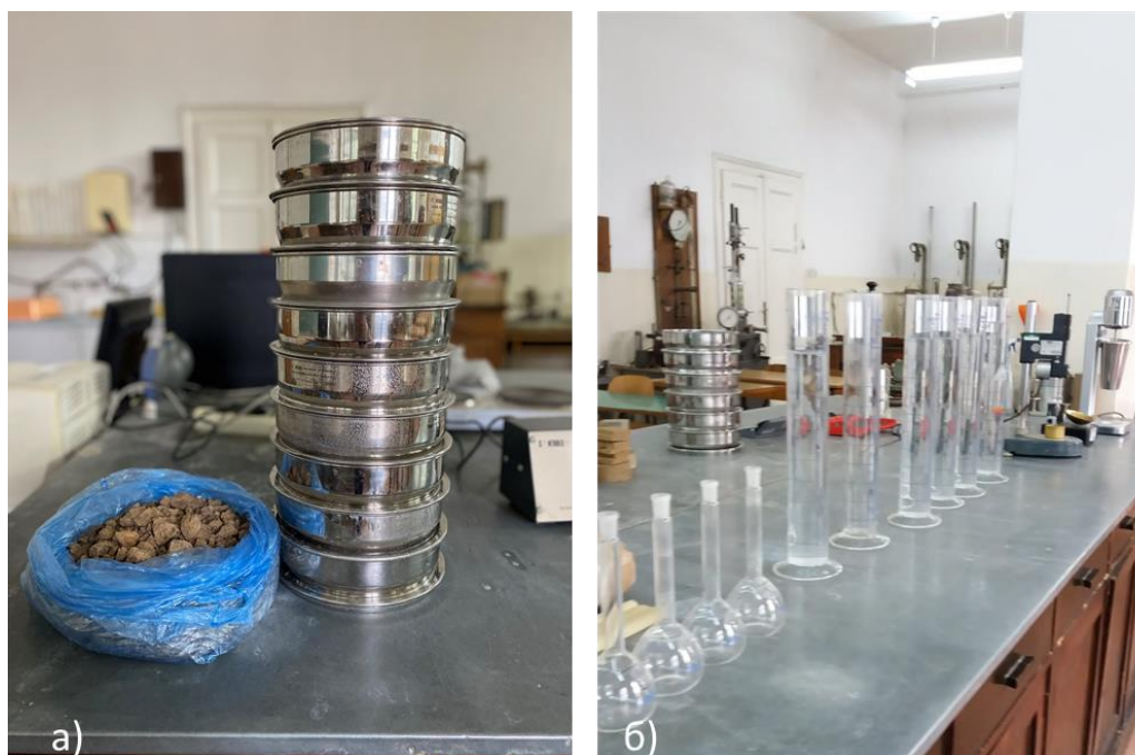
Слика 4.8 а) сита коришћена за одређивање гранулометријског састава б) апаратура коришћена за опит хидрометрисања
