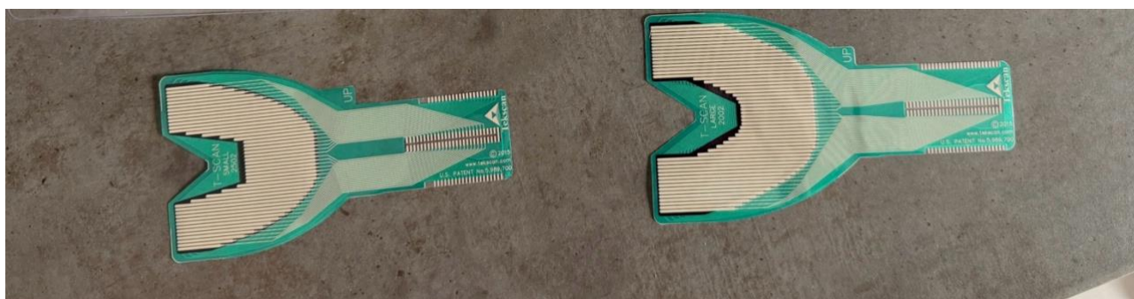
Slika 8. Senzorske folije u manjoj i većoj dimenziji.
