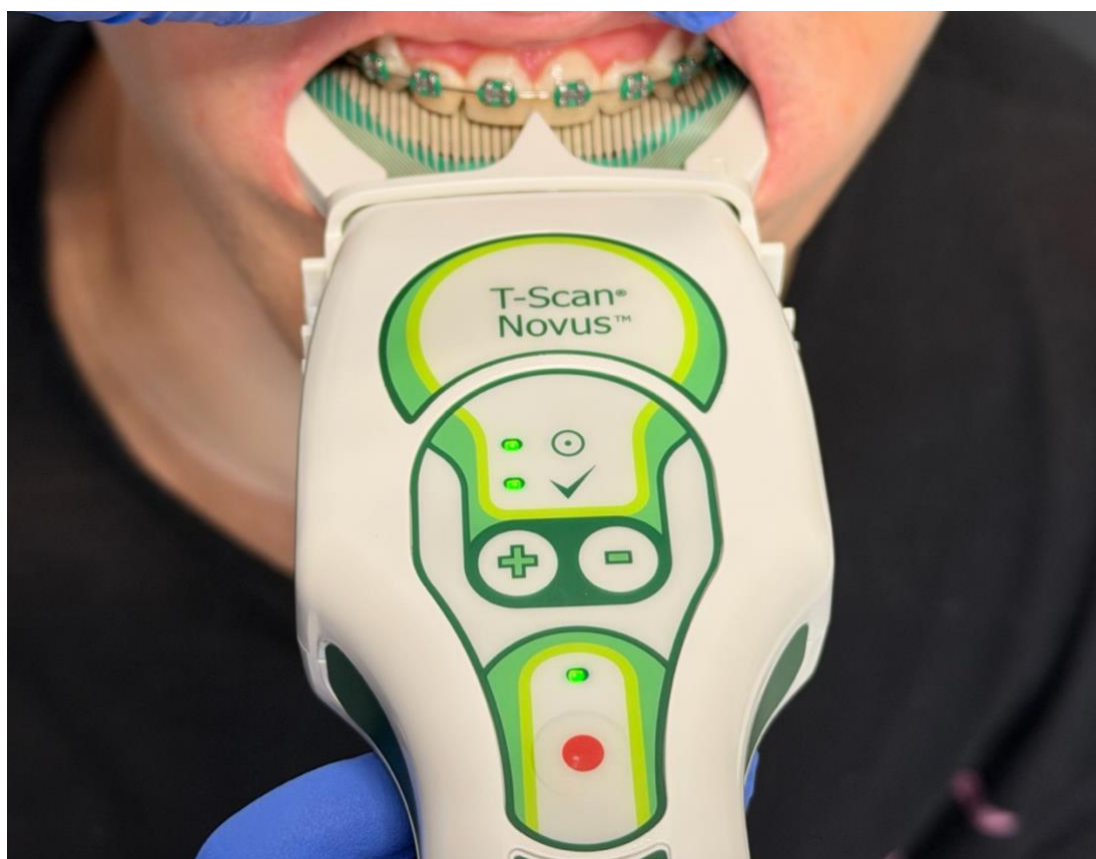
Slika 17. Aktivirano dugme crvene boje na kućištu modula za pokretanje skeniranja.
