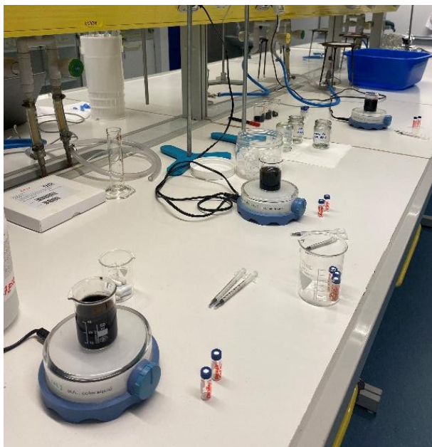
Slika 7. Uzorci zagađene vode pomešani sa biougljem kao adsorbensom.
