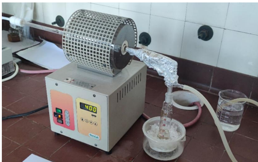
Slika 5. Peć za pirolizu MTF 10/15/130, Carbolite, UK.
