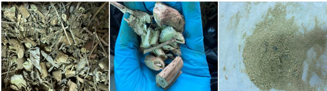
Slika 4. Uzorci biomase duvana i paradajza korišćeni za pirolizu (krupni i usitnjeni uzorci).
