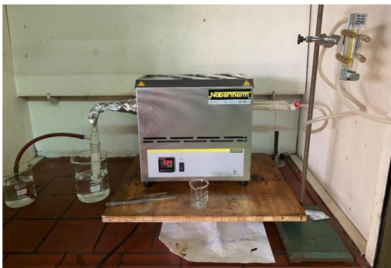
Slika 6. Peć za pirolizu Nabertherm, Kompakt Rohrfen RD, 30/200/11.
