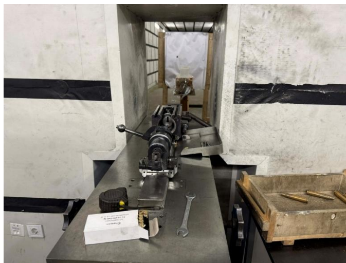
Slika 24: Tunel za balistička ispitivanja sa armirano-betonskom zaštitom – Igman dd, Konjic
