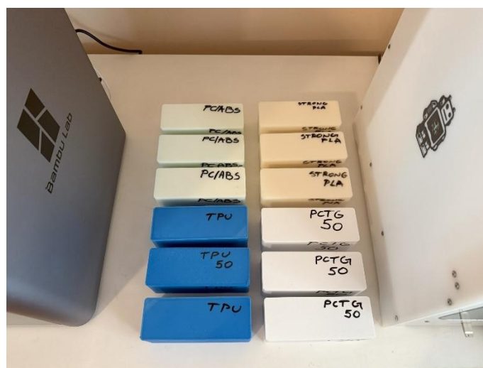
Slika 58: 3D štampane mete od različitih polimera
