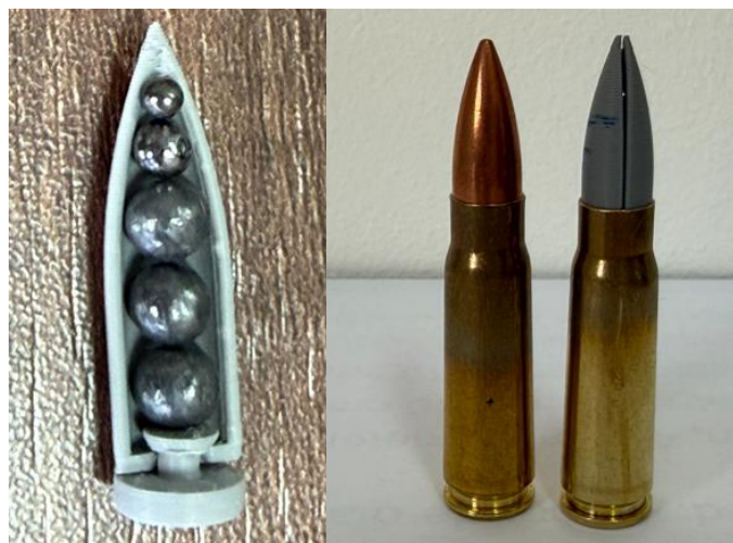
Slika 48: Municija kalibra 7,62 x 39 mm sa originalnim i sa modifikovanim projektilom
