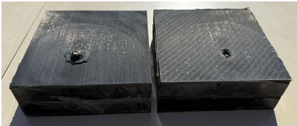
Slika 78: Izgled sendvič panela nakon gađanja i pozicija zaustavljanja projektila kalibra 9 x 19 mm
