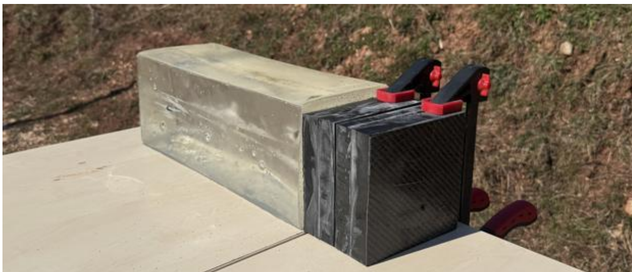
Slika 77: Postavka sendvič panela za eksperimentalno testiranje (nakon gađanja)
