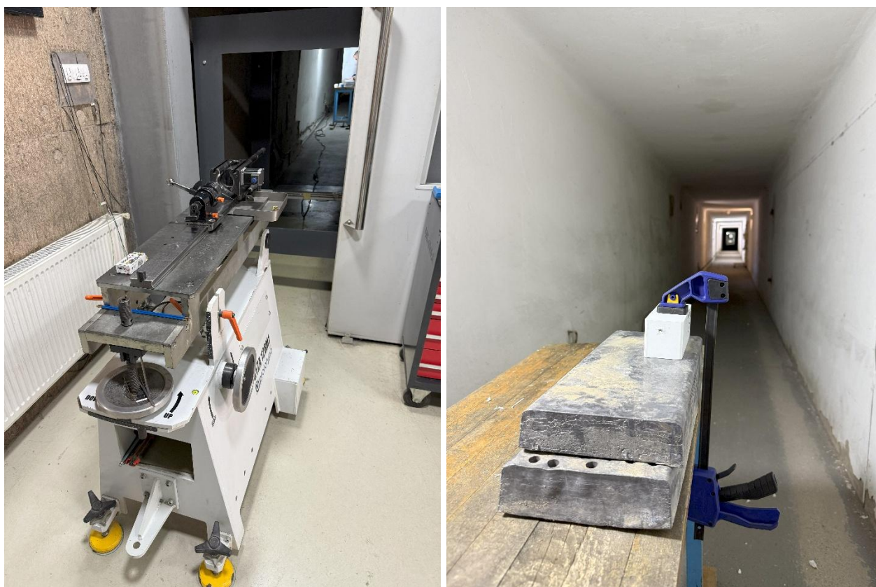
Slika 61: Eksperimentalna postavka za balističko ispitivanje uticaja materijala na opitnom poligonu PTG
