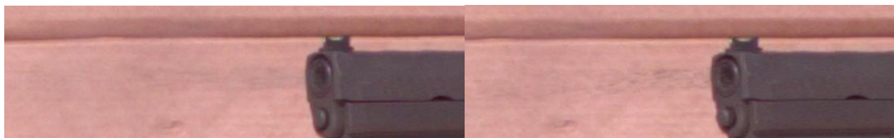
Slika 13: Nesagorjele čestice baruta pri napuštanju cijevi oružja za slučaj opaljenja PLA municije
