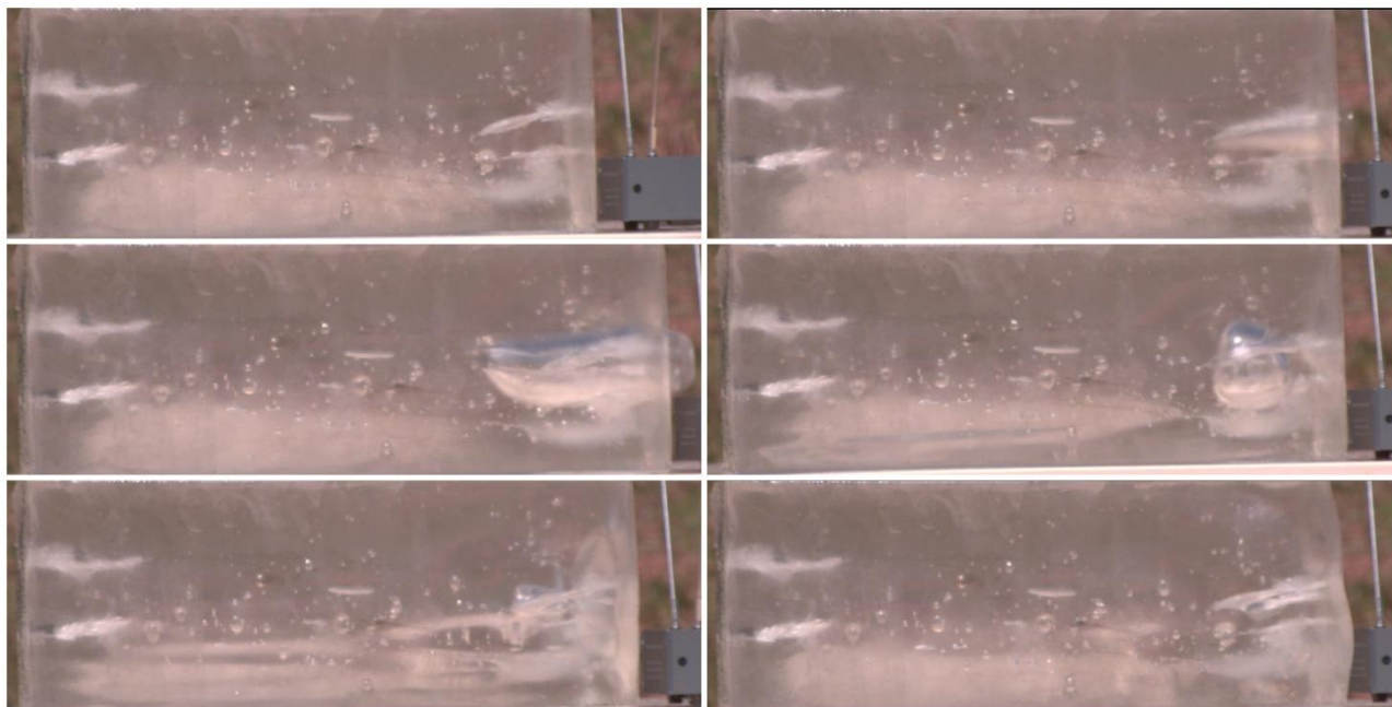
Slika 40: Penetracija PLA projektila ispaljenog iz zagrijane pištoljske cijevi u NATO 20% balistički gel
