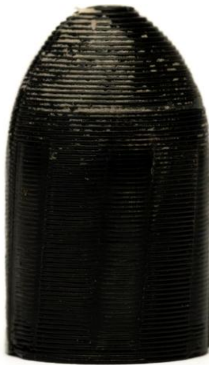
Slika 17: Projektil sa visinom sloja 0.2 mm, PLA
