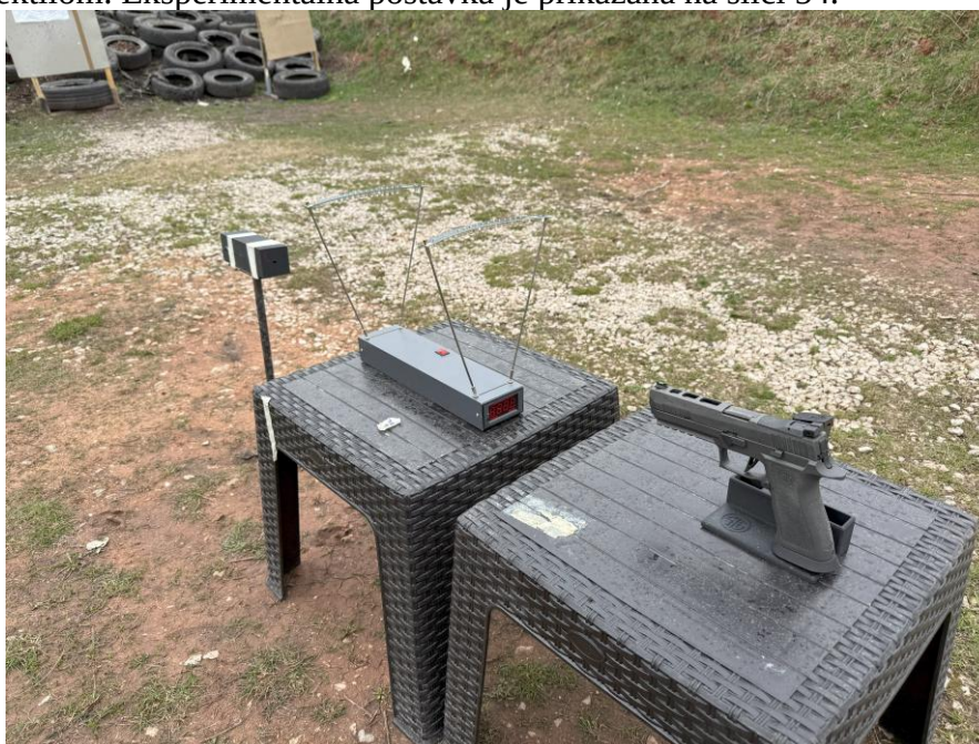
Slika 54: Eksperimentalna postavka za testiranje uticaja geometrije ispune [153]
