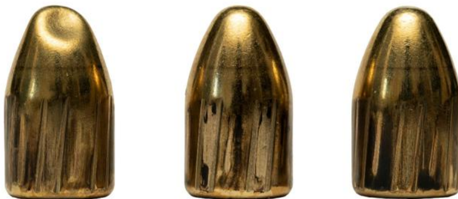
Slika 42: Izgled FMJ projektila nakon penetracije u balistički gel NATO 20%
