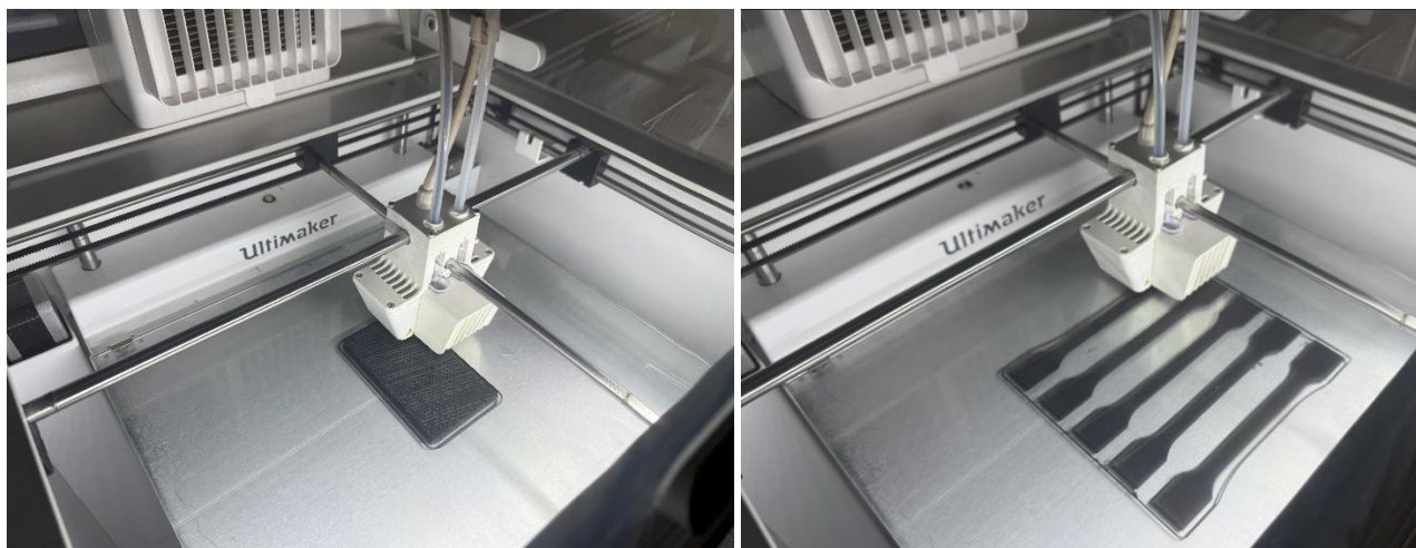
Slika 70: 3D štampa meta za balistička i epruveta za mehanička ispitivanja od PET CF na Ultimaker S5 Pro
