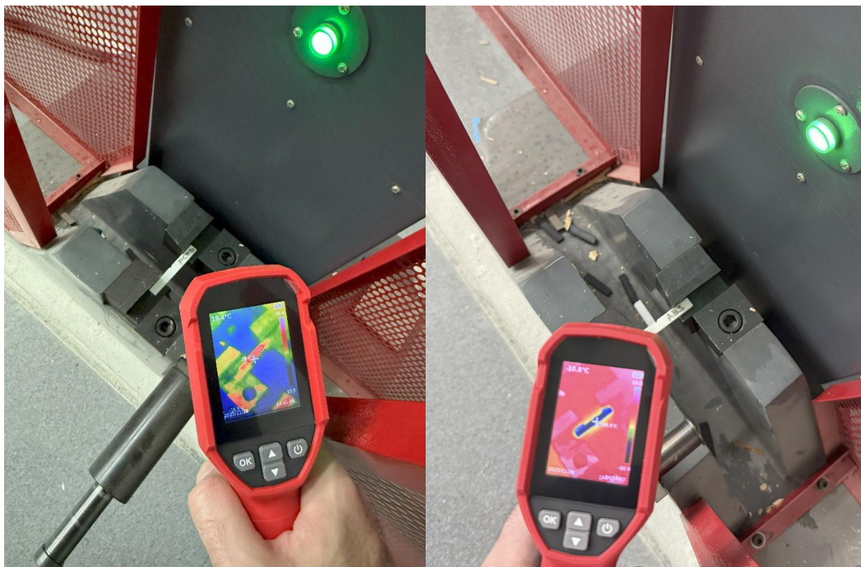
Slika 84: Epruvete pozicionirane za ispitivanje i njihovo mjerenje, sobna temperatura (lijevo) i ohlađena (desno)
