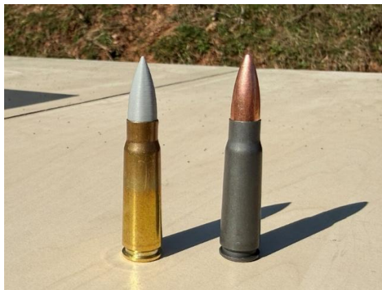
Slika 45: Municija kalibra 7.62 x 39 mm sa polimernim (lijevo) i metalnim (desno) projektilima
