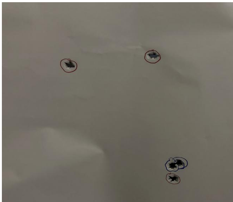
Slika 15: Izgled papirne mete nakon testiranja tačnosti i preciznosti
