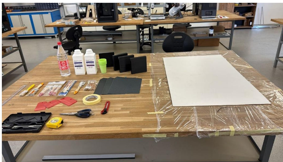
Slika 76: Pribor potreban za izradu sendvič panela karbon - polimer
