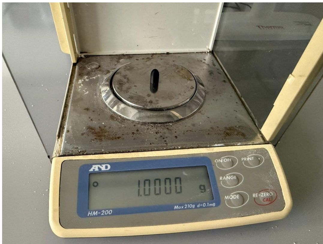
Slika 3: Mjerenje mase PLA projektila izrađenog prema usvojenoj skali na analitičkoj vagi
