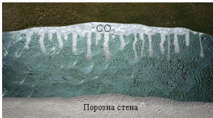
Слика 3.12. Механизам акумулирања услед растварања угљен диоксида у лежишној води (адаптирано из извора: CO 2 Capture Project, n.d.)
