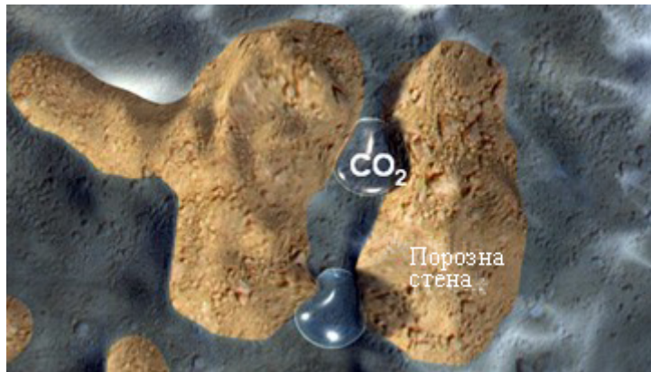
Слика 3.11. Резидуално акумулирање угљен диоксида (адаптирано из извора: CO 2 Capture Project, n.d. )
