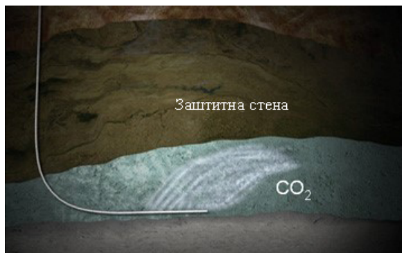
Слика 3.10. Структурно-стратиграфски механизам акумулирања угљен диоксида (адаптирано из извора: \text{CO}_2 Capture Project, n.d.)
