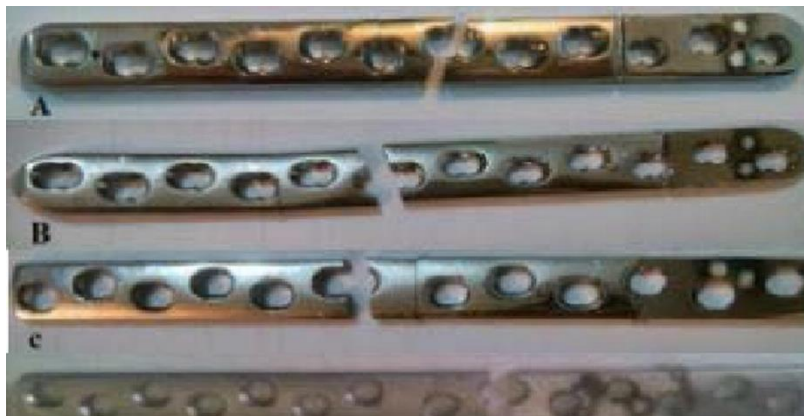
Slika 1.3 Lom usled zamora na ortopedskoj pločici [37].
