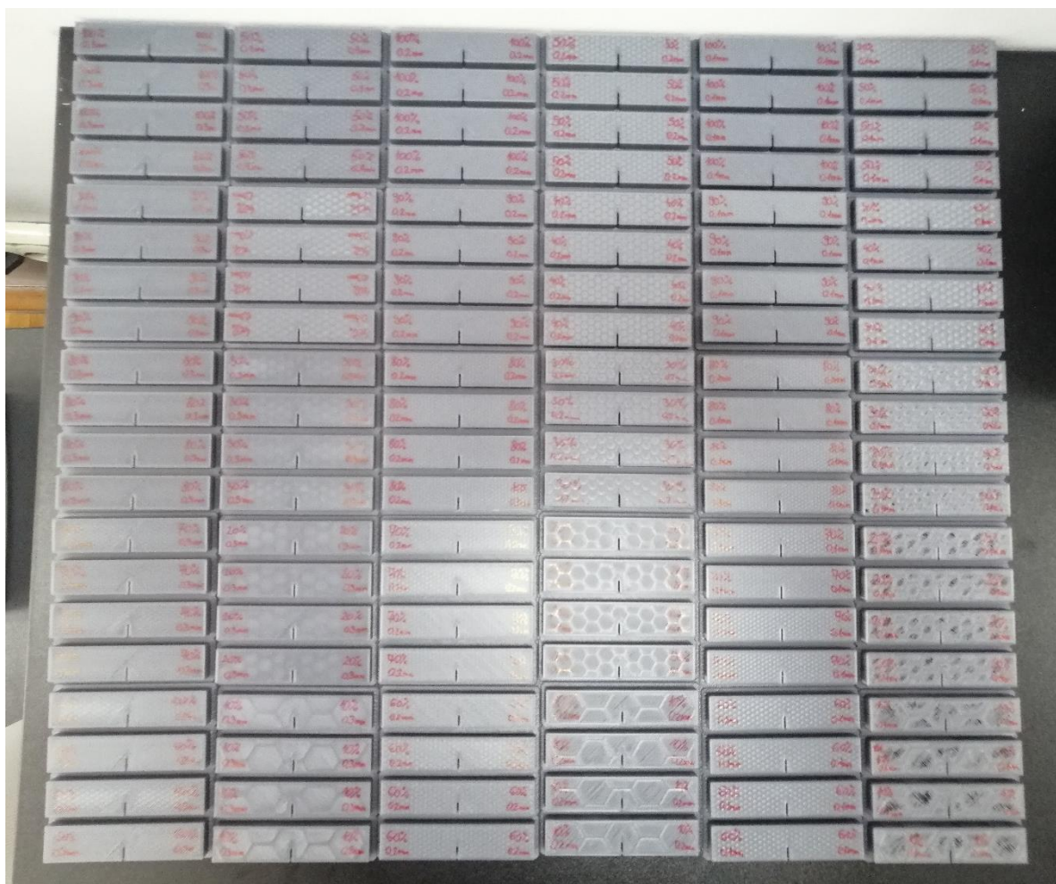
Slika 3.9 Izgled svih epruveta nakon aditivne proizvodnje, korišćenih za ispitivanje žilavosti loma u ovom istraživanju.
