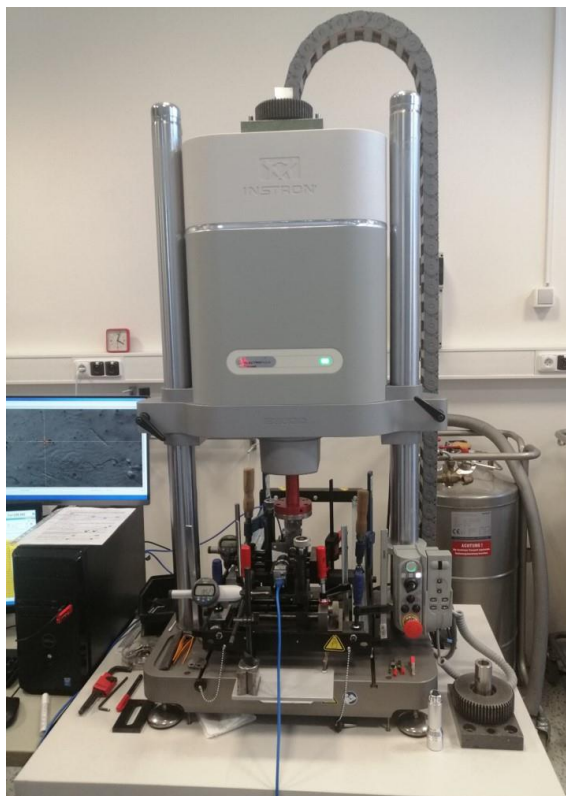
Slika 3.22 Pulzator Instron Electropulse E3000 tokom ispitivanja C(T) epruveta.
