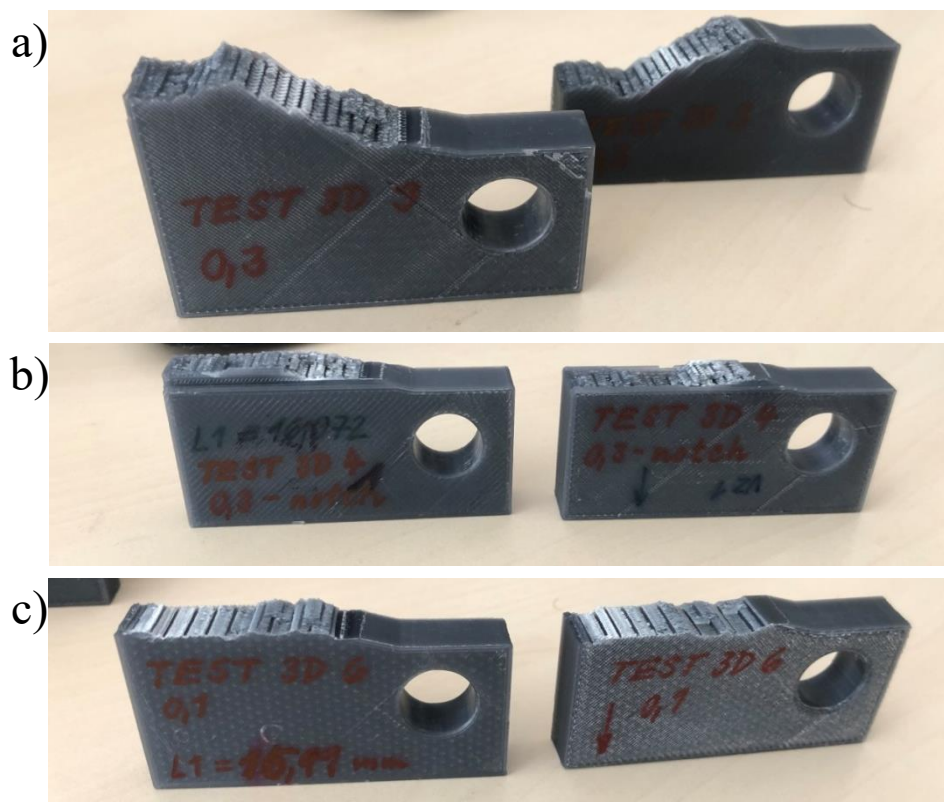
Slika 4.34 Makroskopski izgled C(T) epruveta nakon završenog ispitivanja zamornog rasta prsline za: a) 0.3 mm (glatka epruveta); b) 0.3 mm sa bočnim zarezima; c) 0.1 mm visine sloja [79].
