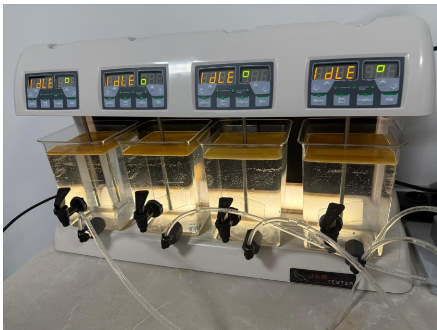
Слика 3.11.JAR DAF тестирање након завршне фазе мешања (Серија 7)
