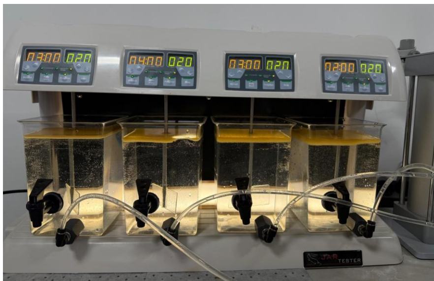
Слика 3.13. Експеримент у серији 9 при различитом времену уноса ваздуха
