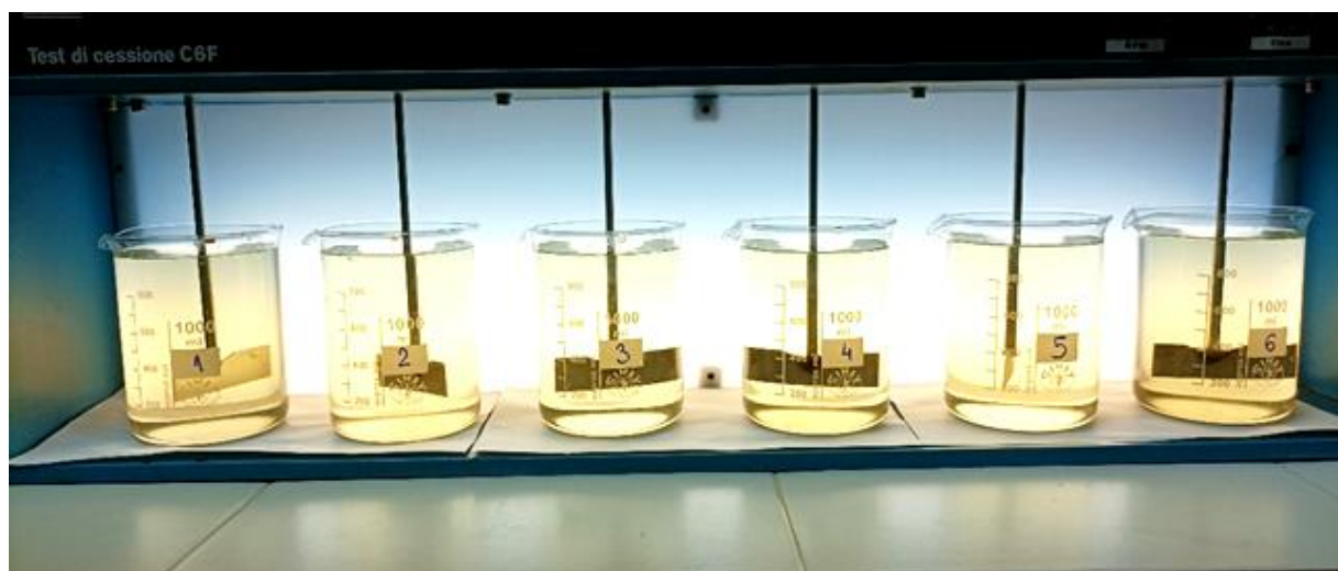
Слика 3.2. JAR узорци 1- мешање након дозирања хемикалија. (узорци S1-S6)
