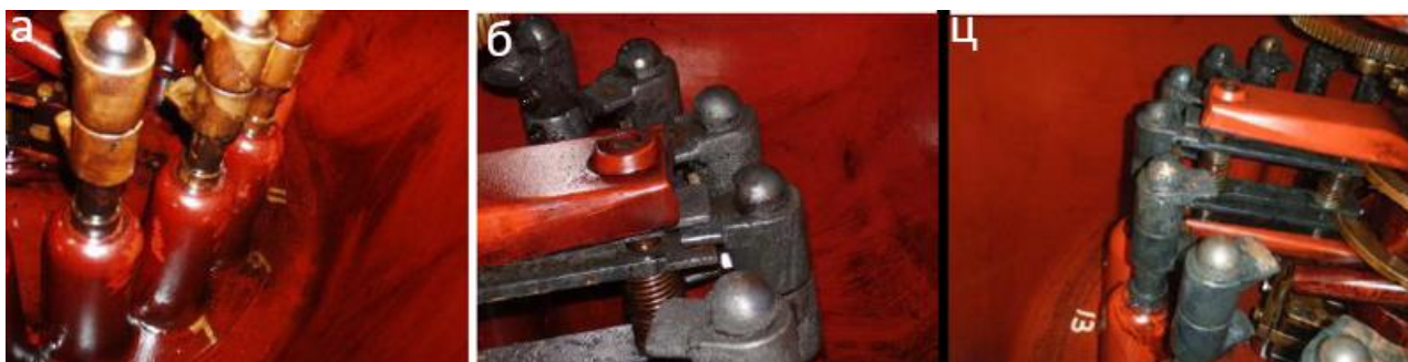
Слика 2. Пример корозије сребра (а) пре регенерације уља, (б) годину дана након регенерације уља и (ц) након три године ван погона [10].
