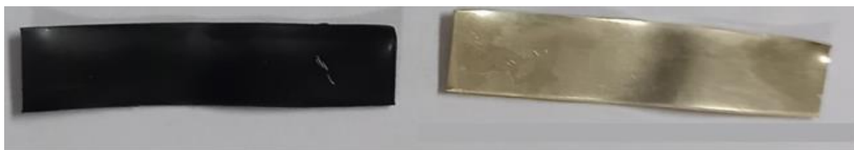
Слика 50. Изглед сребрне плочине након ASTM D1275-15 теста корозивности уља пре (лево) и након третмана уља (десно), експеримент 1.
