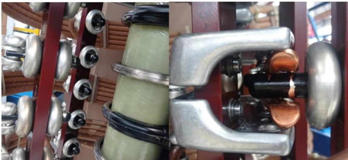
Слика 7. Посребрени контакт ТРП који је био изложен дејству корозивног сумпора [48]
