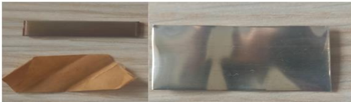
Слика 33. Изглед изолационог папира и бабра након теста корозије према IEC 62535 лево и сребрне плочице након DIN 51353 стандарда десно, након третмана уља, (експеримент 2).
