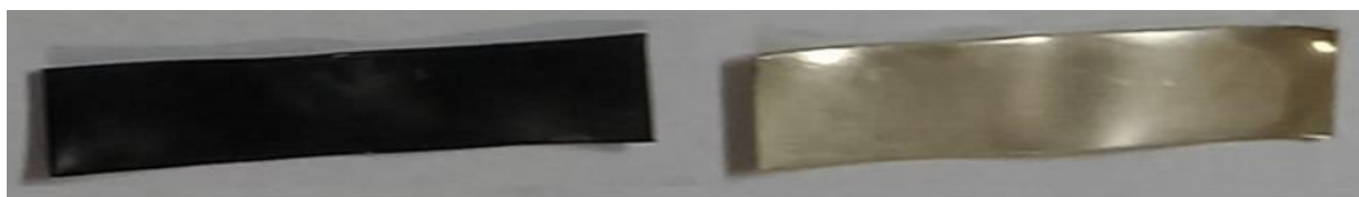
Слика 56. Изглед сребрне плочине након ASTM D1275-15 теста корозивности уља пре (лево) и након третмана уља (десно), експеримент 3.
