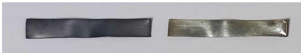
Слика 37. Изглед сребрних плочица након ASTM D1275-15 теста корозије, пре третмана (лево) и након третмана (десно), експеримент 6.
