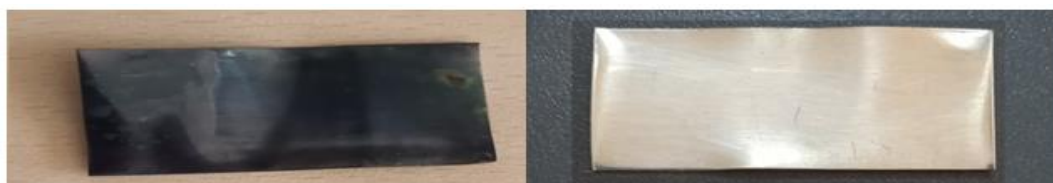
Слика 36. Изглед сребрних плочица након DIN 51353 теста корозије, пре третмана (лево) и након третмана (десно), експеримент 6.
