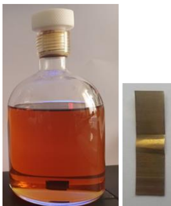
Слика 11. Тест корозије према ASTM D1275-15 стандарду [63].
