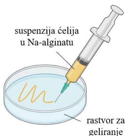
Slika 3.1. Šema dobijanja mikrovlakana sa imobilisanim ćelijama pomoću šprica i igle, ručnim istiskivanjem suspenzije ćelija u Na-alginatu u rastvor za geliranje
