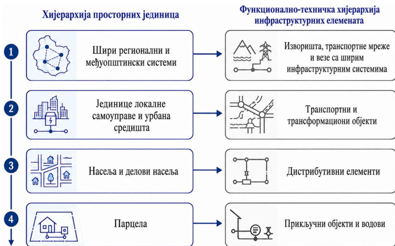
Слика 2. Кореспонденција између хијерархије просторних јединица и функционално-техничке хијерархије инфраструктурних елемената
