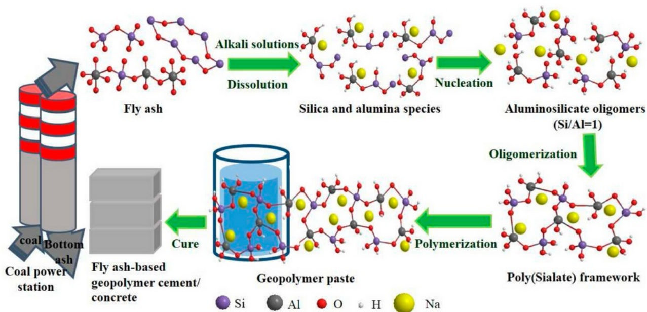
Slika 3.2. Šematski prikaz dobijanja alkalno aktiviranih veziva [29].
