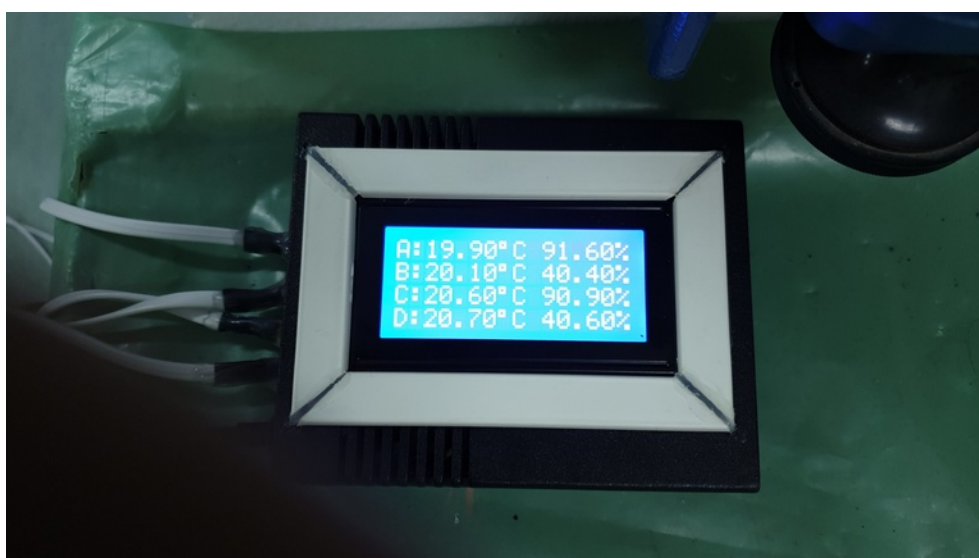
Slika 5.16. Indikator temperature i relativne vlažnosti u radu.
