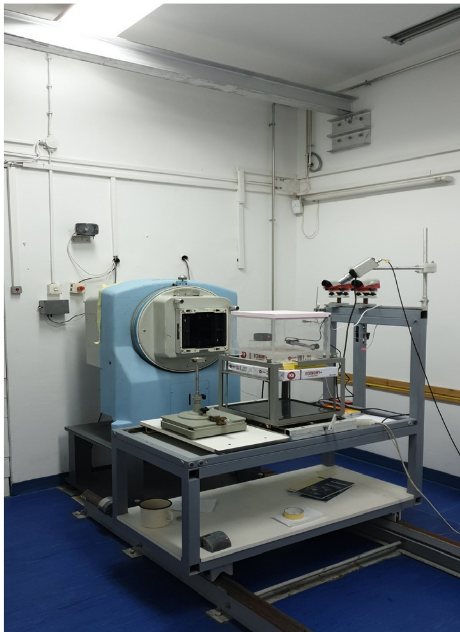
Slika 5.21. Pozicioniranje klima komore i kalupa u polju uređaja IRPIK-B.
