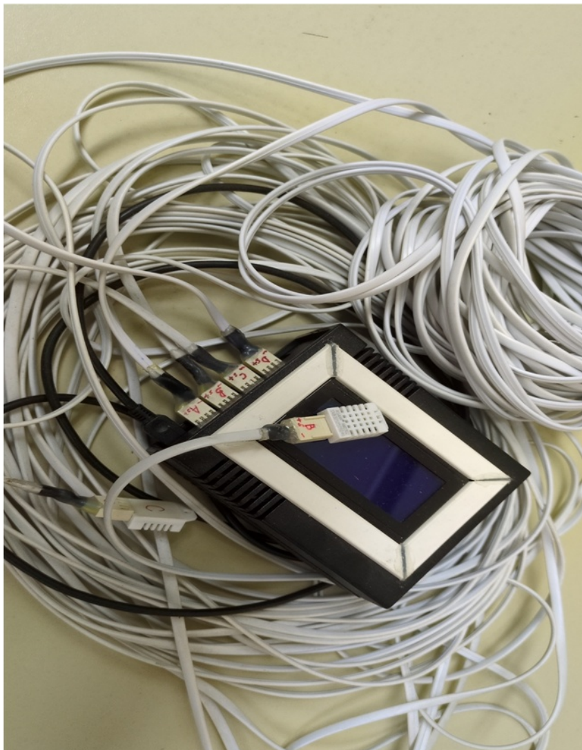
Slika 5.15. Indikator temperature i relativne vlažnosti, sa kablovima i DHT22 senzorima.
