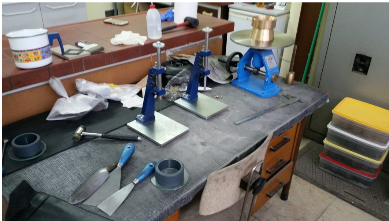
Slika 5.4. Oprema za kontrolu kvaliteta cementne paste: kalup, Vicat aparati sa iglom i klipom (plunger), sto za rasprostiranje, ručni alati
