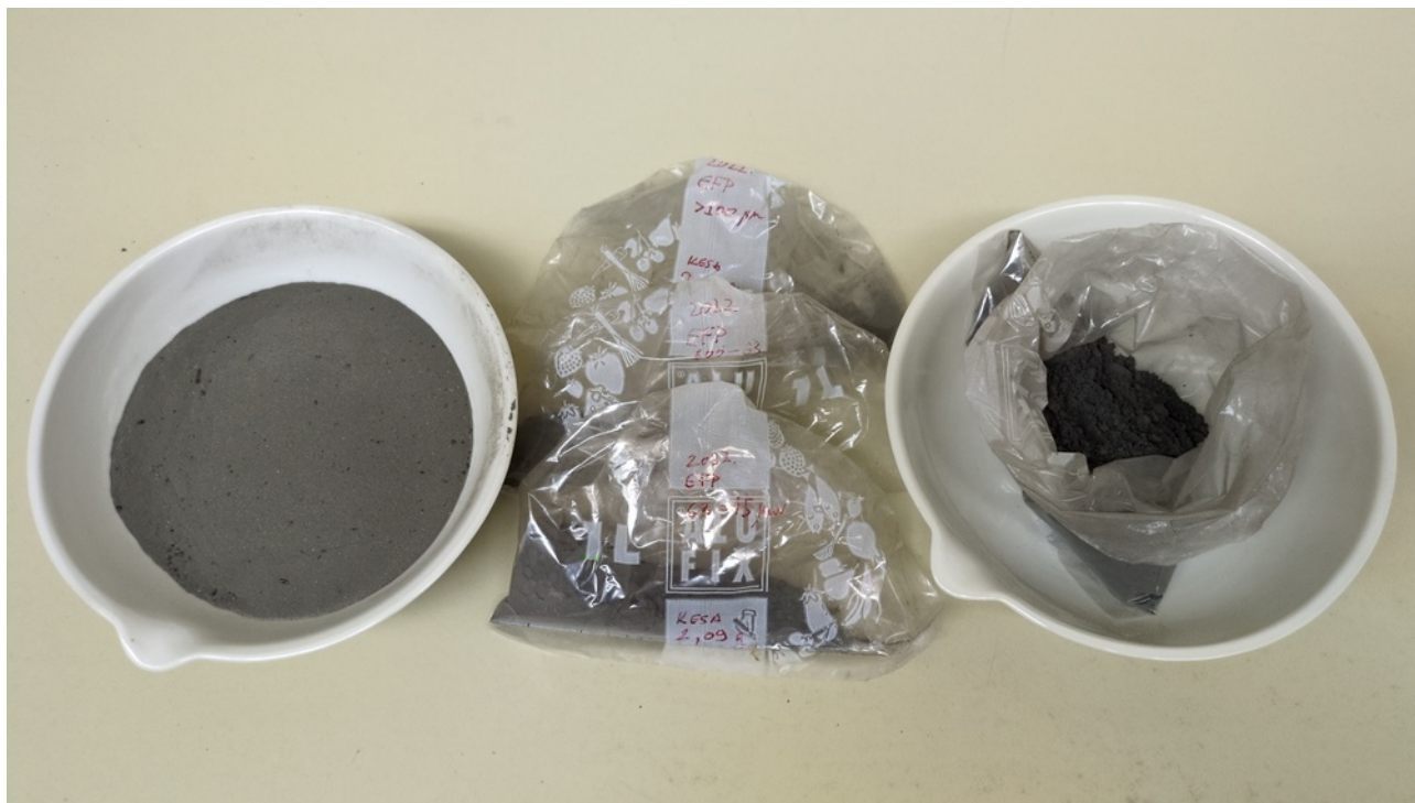
Slika 5.5. Kompozit elektrofilterski pepeo (levo) i frakcija pepela sa česticama manjim od 45 mikrona (desno).
