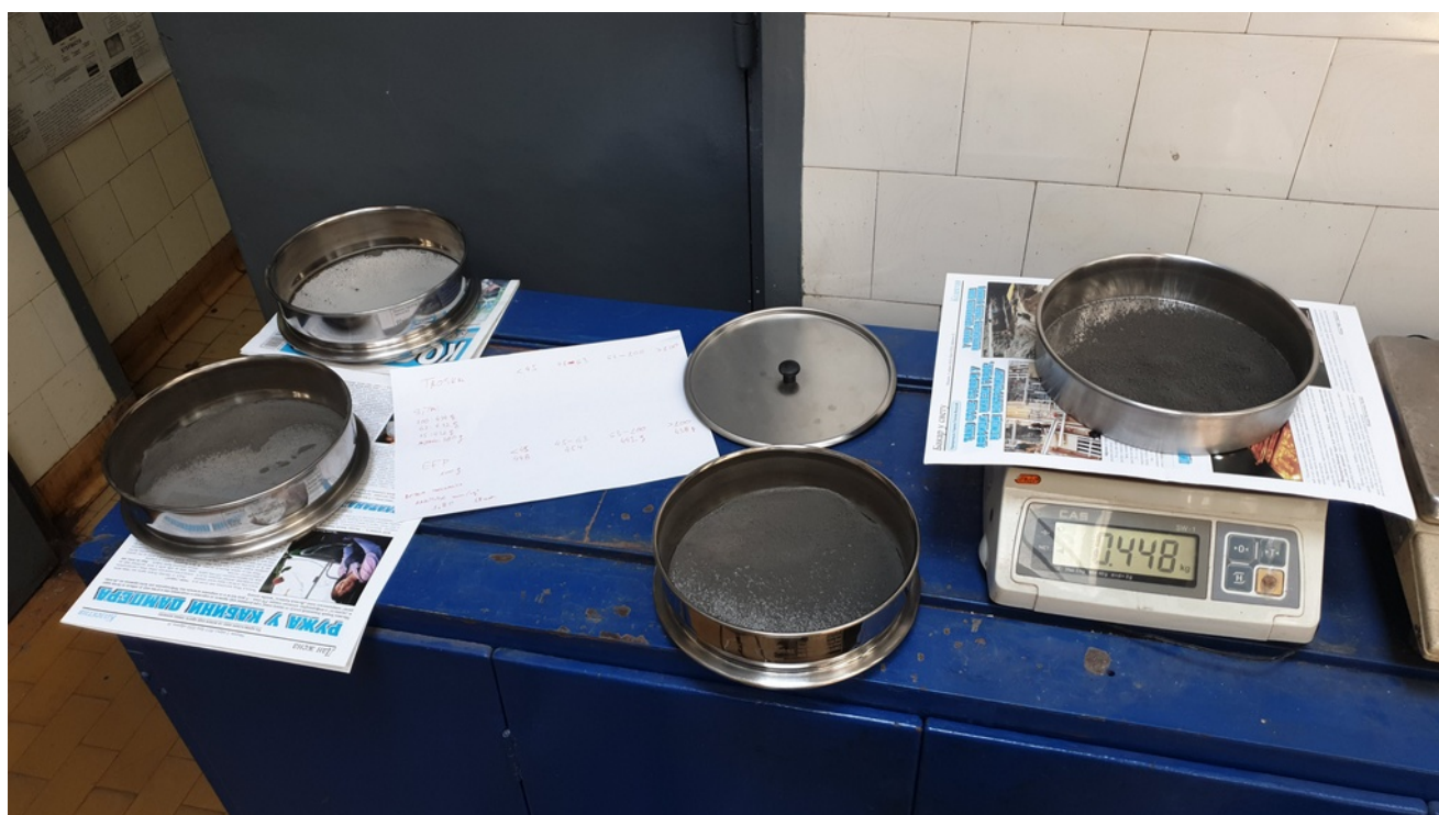
Slika 5.18: Merenje mase frakcija praha odvojenih suvim prosejavanjem na standardnim sitima.
