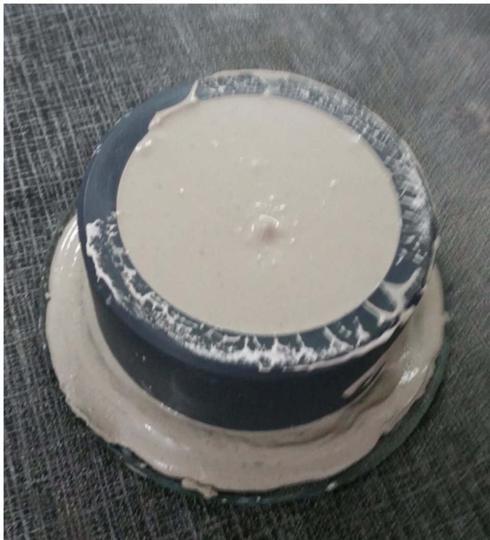
Slika 3.3. Sveža BFS pasta aktivirana vodenim staklom, u kalupu za određivanje vremena očvršćavanja
