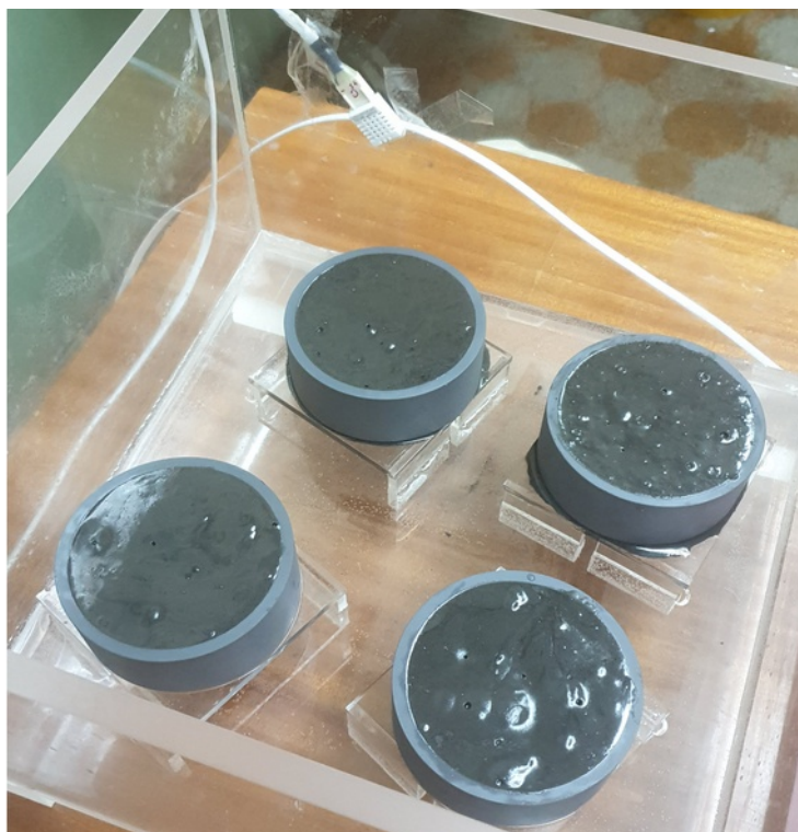
Slika 5.20. Sveže paste letećeg pepela u kalupima u komori, vidljiva pozicija DHT22 senzora.
