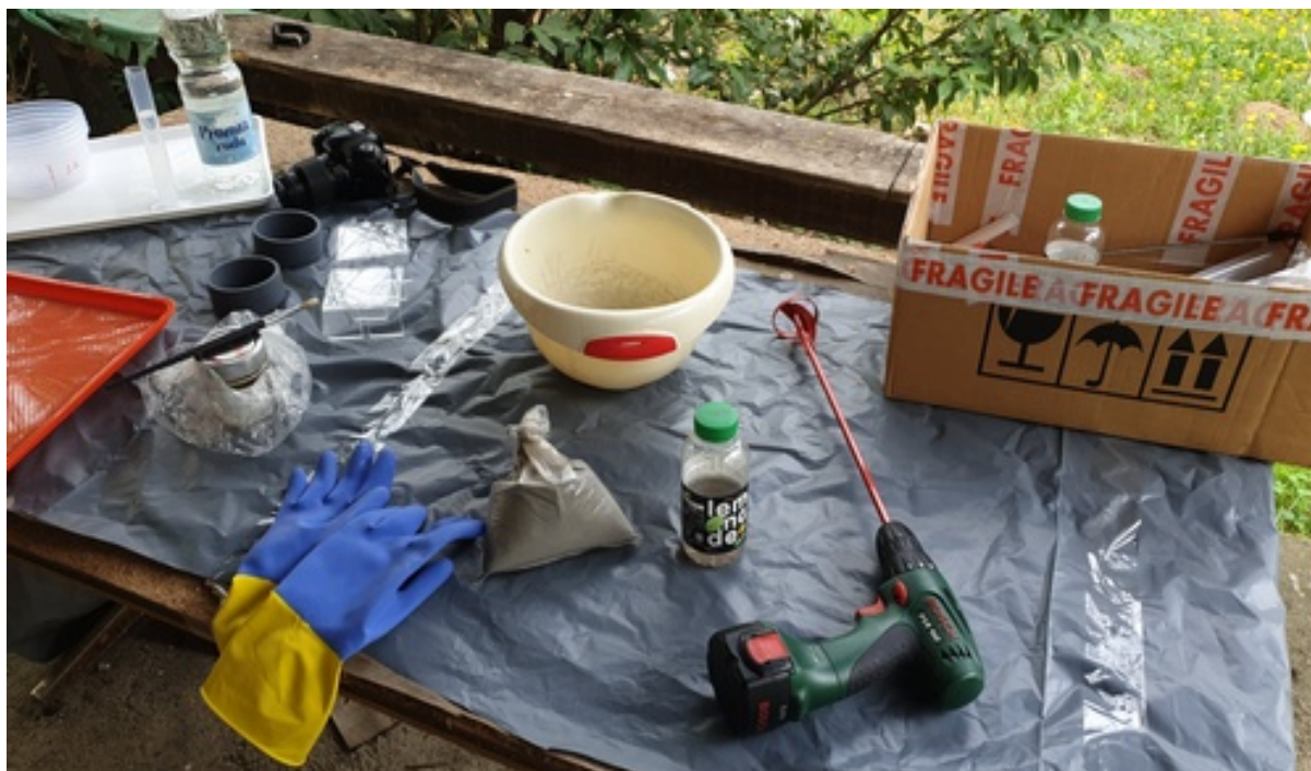
Slika 5.9. Priprema uzorka: kalupi, prethodno odmereni prah i aktivator, ručni mešać.
