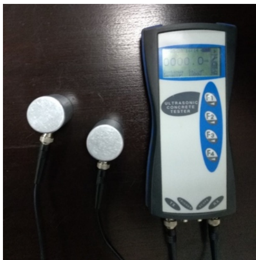
Slika 5.24. Matest uređaj za UPV i merenje debljine uzorka.
