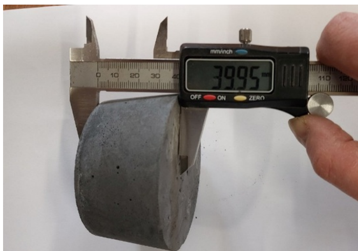
Slika 5.24. Matest uređaj za UPV i merenje debljine uzorka.
