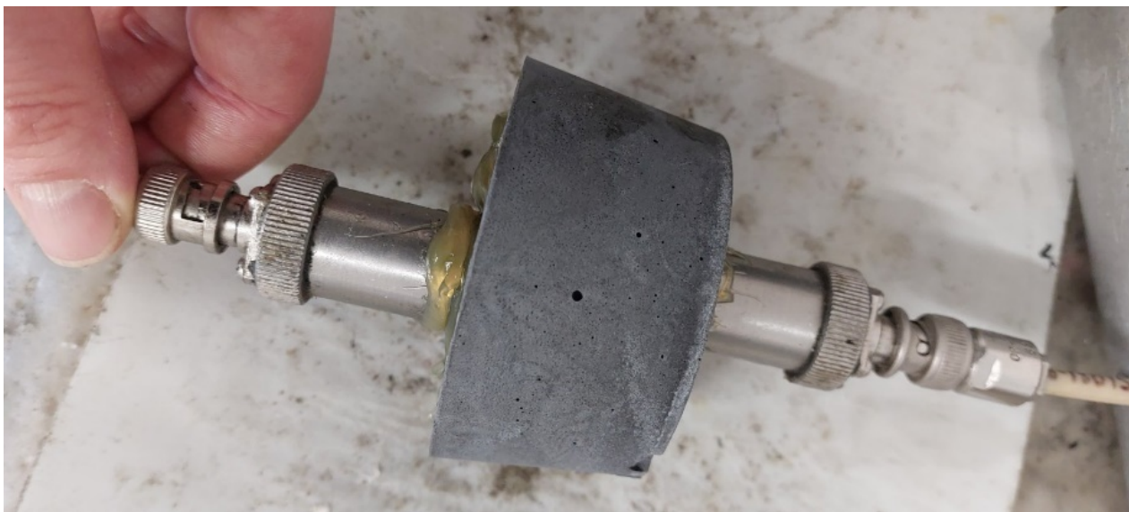
Slika 5.25. Ultrazvučne sonde pozicionirane na očvrslu uzorak paste.
