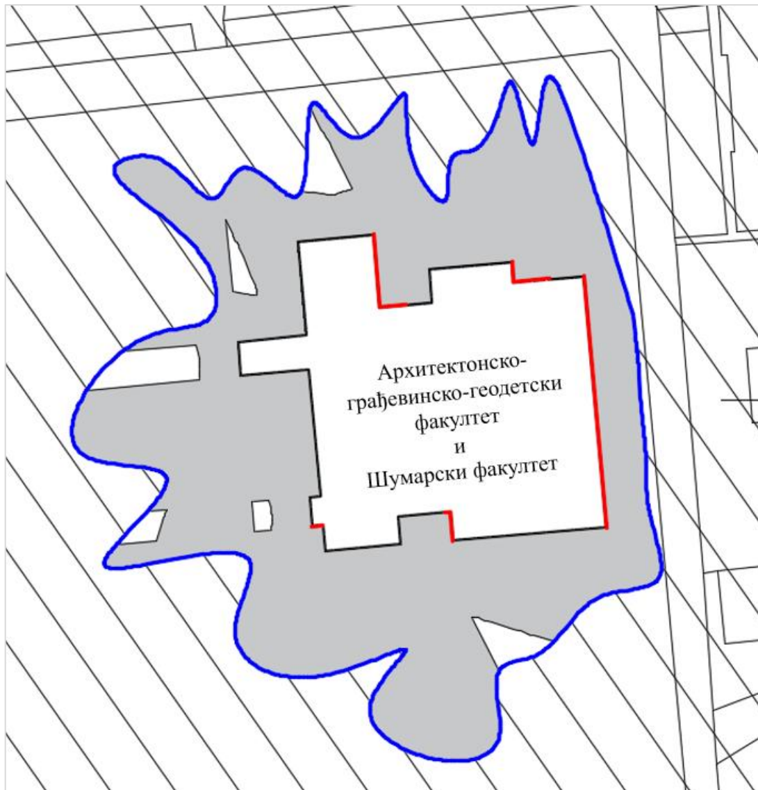
Слика 4-6. Допустива област постављања скенера (неишрафирани/необојени дијелови изван објекта) при \alpha_{\max} = 65^\circ за зграду Архитектонско-грађевинско-геодетског и Шумарског факултета. Висина објекта - H \approx 15 m. Висина инструмента - i \approx 1.5 m. Дио објекта који није могуће скенирати означен је црвеном линијом.
