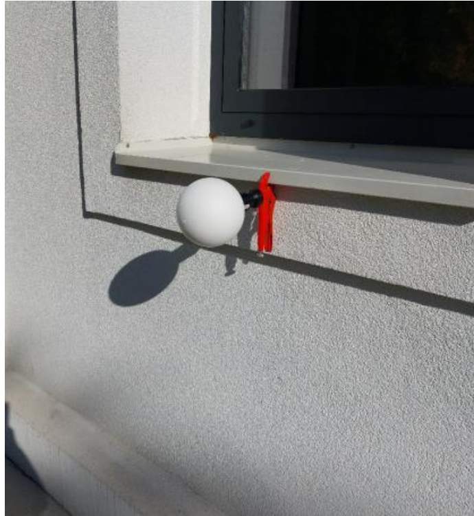
Слика 5-4. Сферни скенерски сигнал на објекту (скенерски сигнал са ознаком ОВ3)
