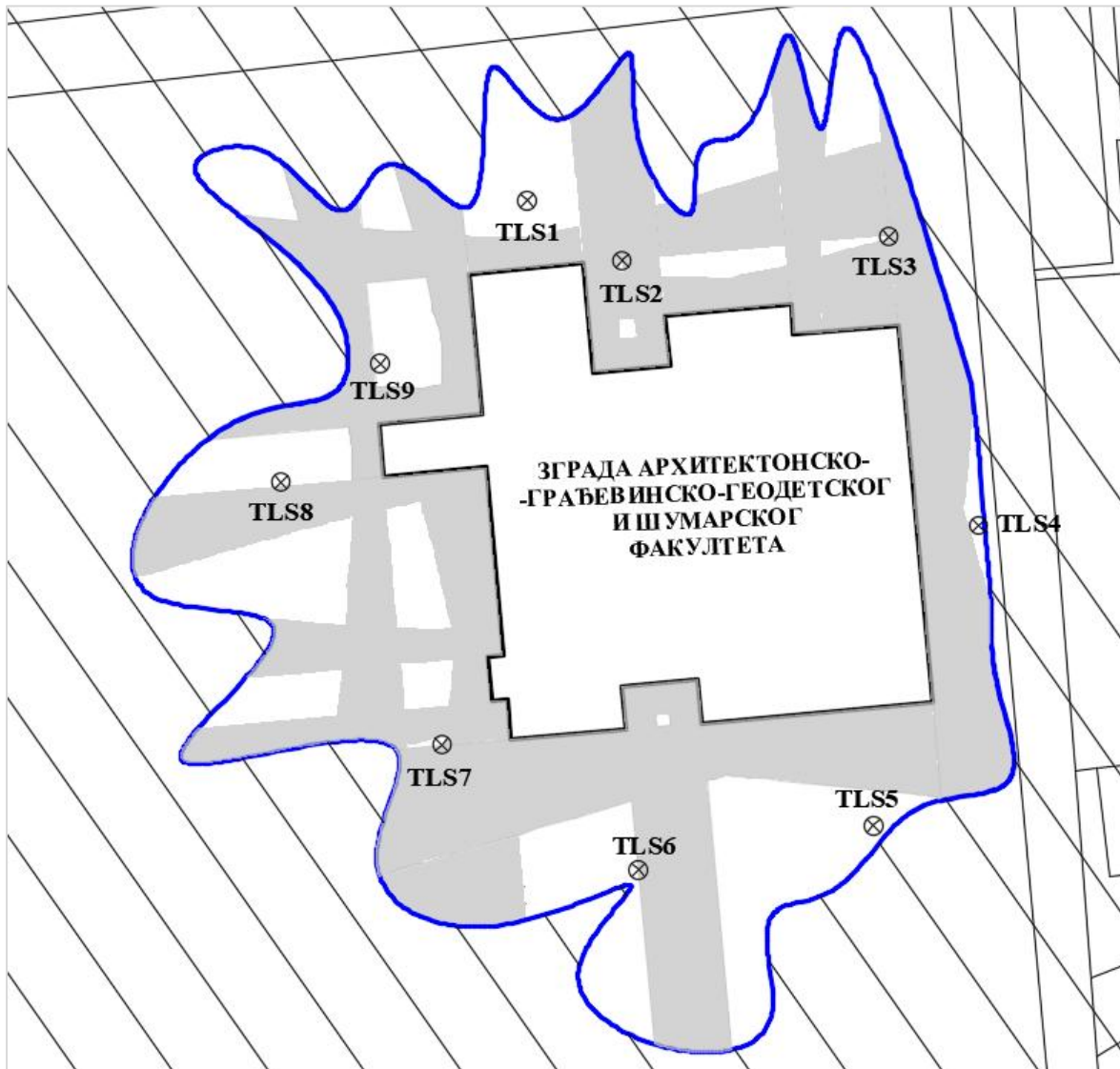
Слика 4-9. 2Д приказ распореда станица ТЛС унутар допустиве области, за који је остварена потпуна покривеност објекта
