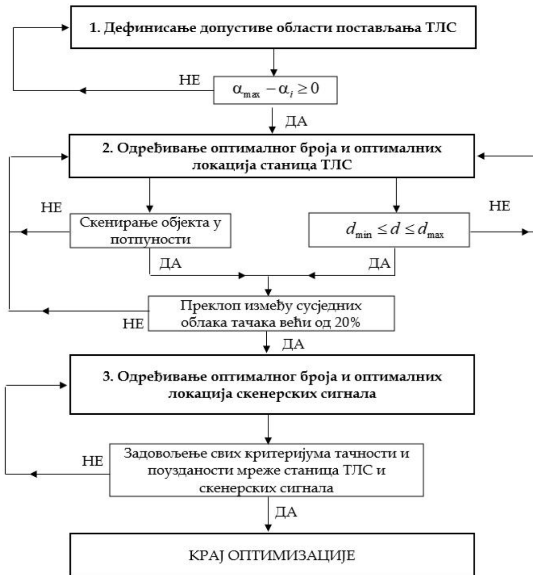
Слика 3-1. Дијаграм тока процеса оптимизације геометрије ТЛС мреже
