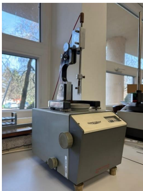
Слика 3.6. Уређај коришћен за мерење густине узорака урањањем у живу.
