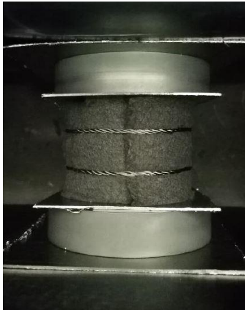
Слика 3.4. Графитни калуп коришћен приликом спарк плазма синтеровања.
