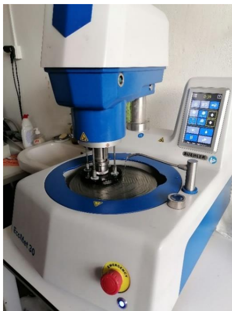
Слика 3.5. EcoMet 300/AutoMet 300 уређај коришћен за брушење и полирање узорака.
