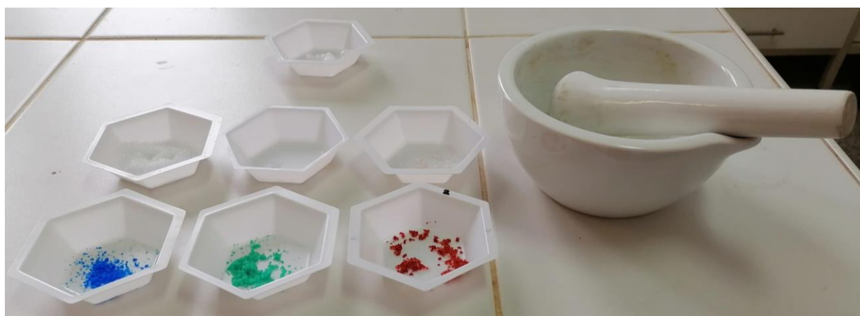
Слика 3.1. Измерене стехиометријске количине прекурсора коришћених за синтезу (\text{Co}, \text{Mn}, \text{Ni}, \text{Zn}, \text{Cu})\text{Al}_2\text{O}_4 и аван коришћен у експерименталном раду.
