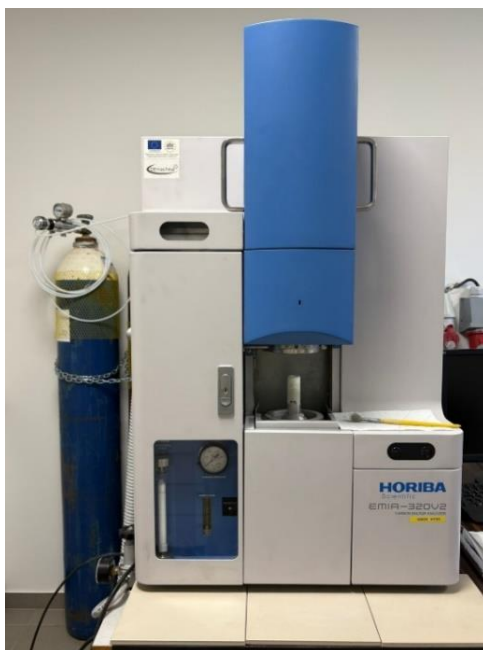
Слика 3.7. EMIA-320 V2 AC HORIBA Jobin Yvon анализатор угљеника/сумпора (C/S) коришћен за мерење заосталог угљеника у узорцима.
