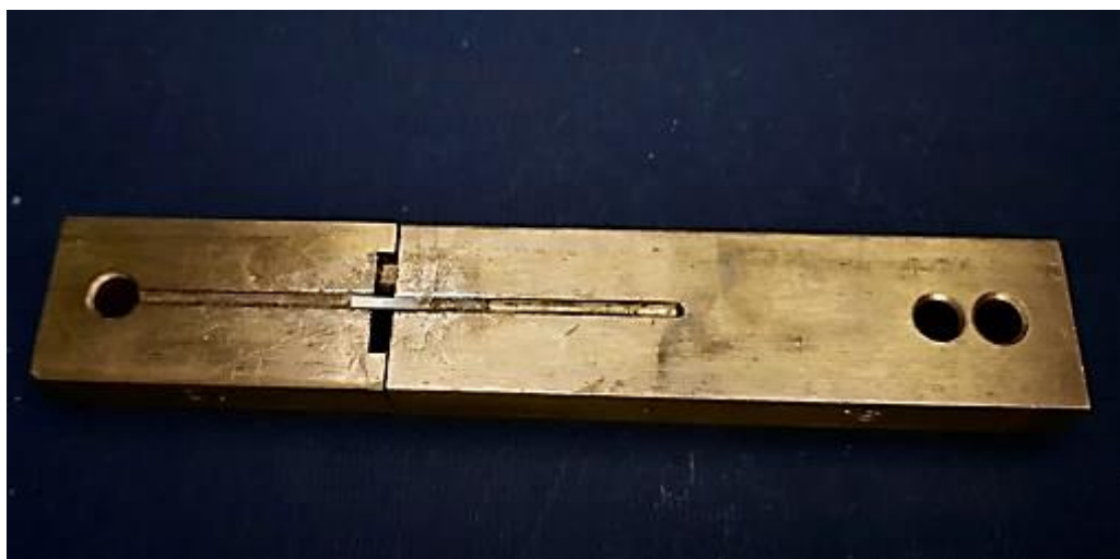
Слика 7. Узорак (штапић) причвршћен за плочице машине за тестирање отпорности на микроистезање.
