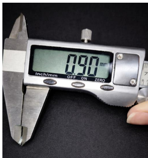
Слика 6. Мерење дебљине штапића помоћу дигиталног нонијуса.
