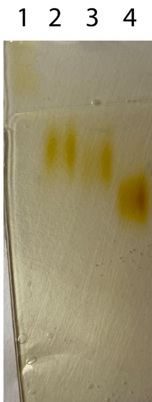
Slika 23. Nativna elektroforeza gde je kao susprtat korišćen 5% pirogalol 1-komercijalni HRP; 2- 2,5 mM oxHRP; 3- 5,0 mM oxHRP; 4- 50,0 mM oxHRP
