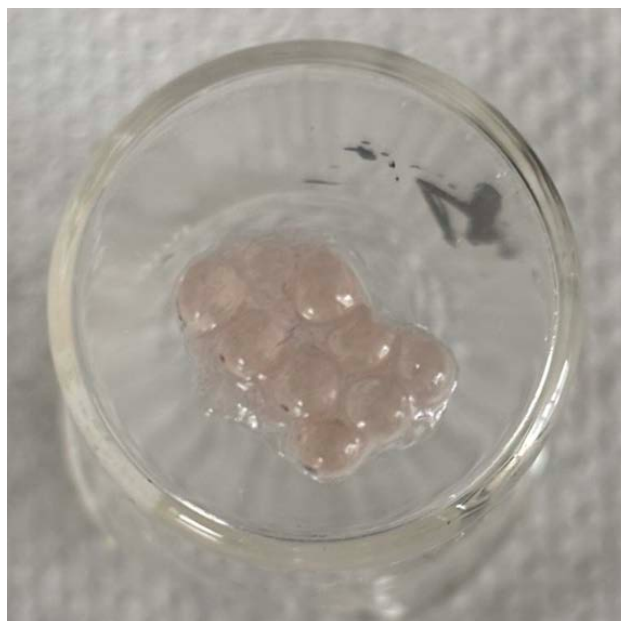
Slika 77 Izgled kuglica hibridnog biokompozita HRP@ZIF-8@ALG nakon drugog ciklusa dekolorizacije boje Methyl Orange
