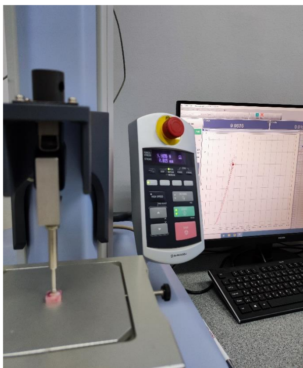
Слика 13. Изглед апарата и процес мерења микротврдоће: сонда мерача усмерена на површину глеђи зуба.
