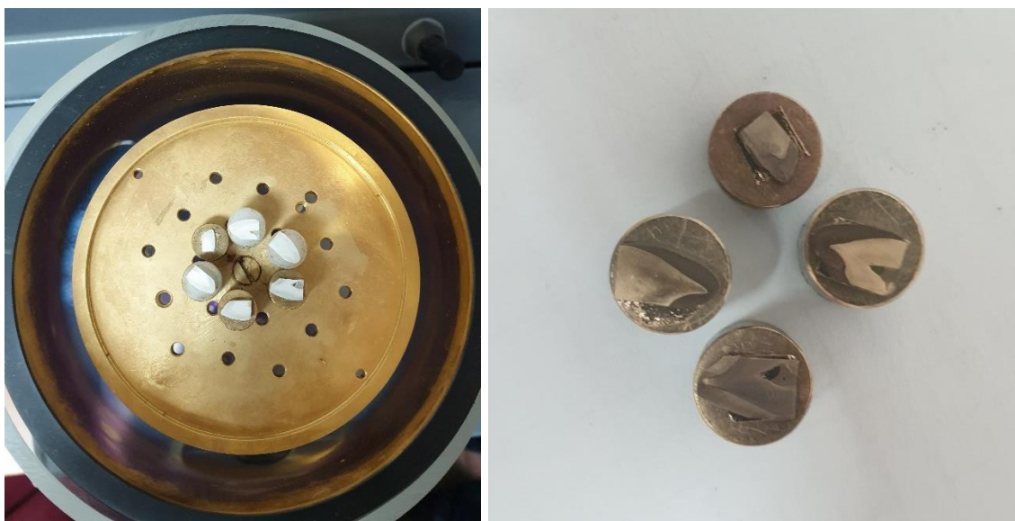
Слика 6. Узорци напарени златом и постављени на металне држаче.
