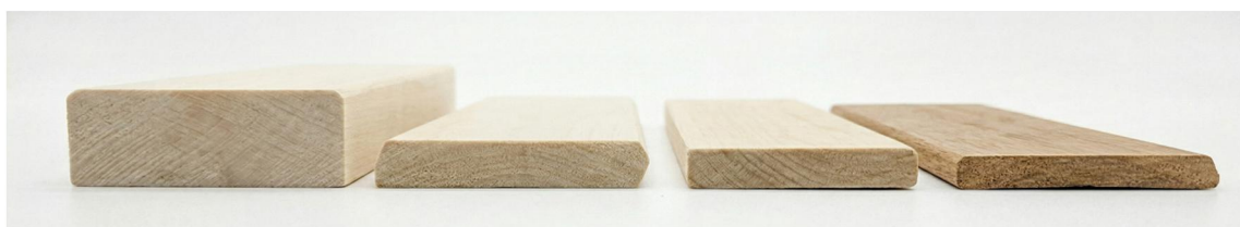
Slika 9. Uzorci pre densifikacije (početna debljina 20 mm) i nakon upresovanja u radijalnom pravcu na ciljane debljine od 10 mm, 8 mm i 7 mm, što odgovara nominalnim stepenima upresovanja (CR) od 50%, 60% i 65%.
