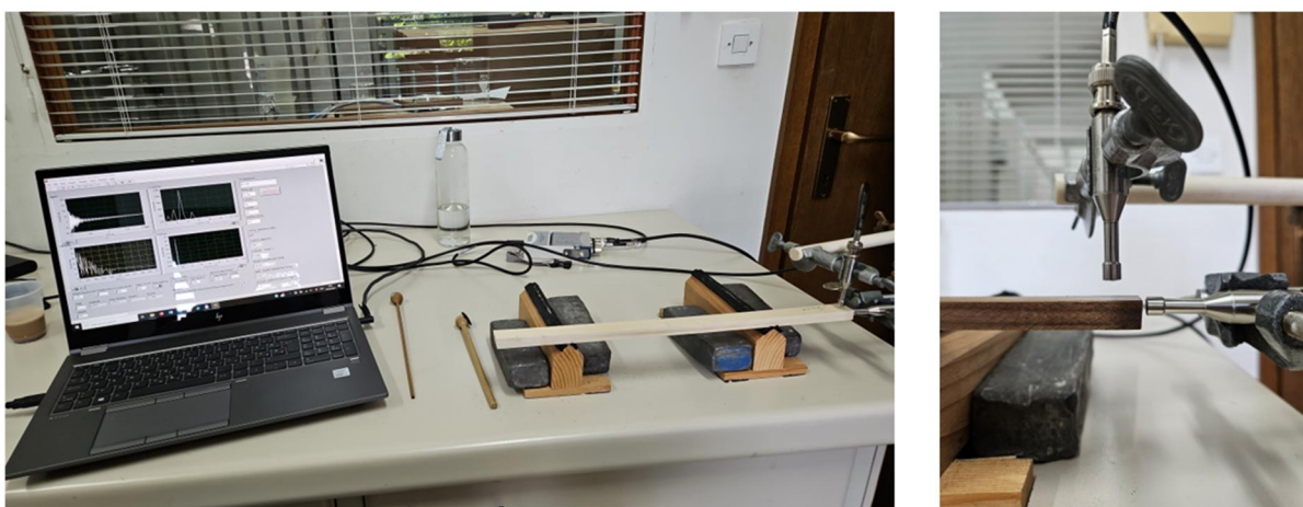
Slika 16. Eksperimentalna postavka za određivanje dinamičkog modula ( E_d ) elastičnosti kod longitudinalnog i savojnog moda oscilovanja, metodom slobodnih rezonantnih vibracija
