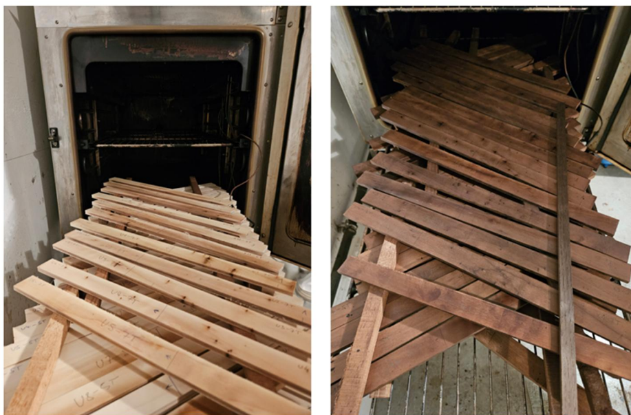
Slika 11. Uzorci iz grupa TM i US+TM, pre termičkog tretmana (levo) i posle termičkog tretmana (desno)
