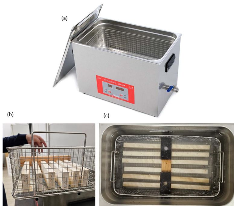
Slika 7. Ultrazvučni tretman u destilovanoj vodi: (a) laboratorijska ultrazvučna jedinica Asonic Pro300; (b) raspored uzoraka u korpi pre potapanja; (c) položaj i fiksiranje uzoraka tokom tretmana
