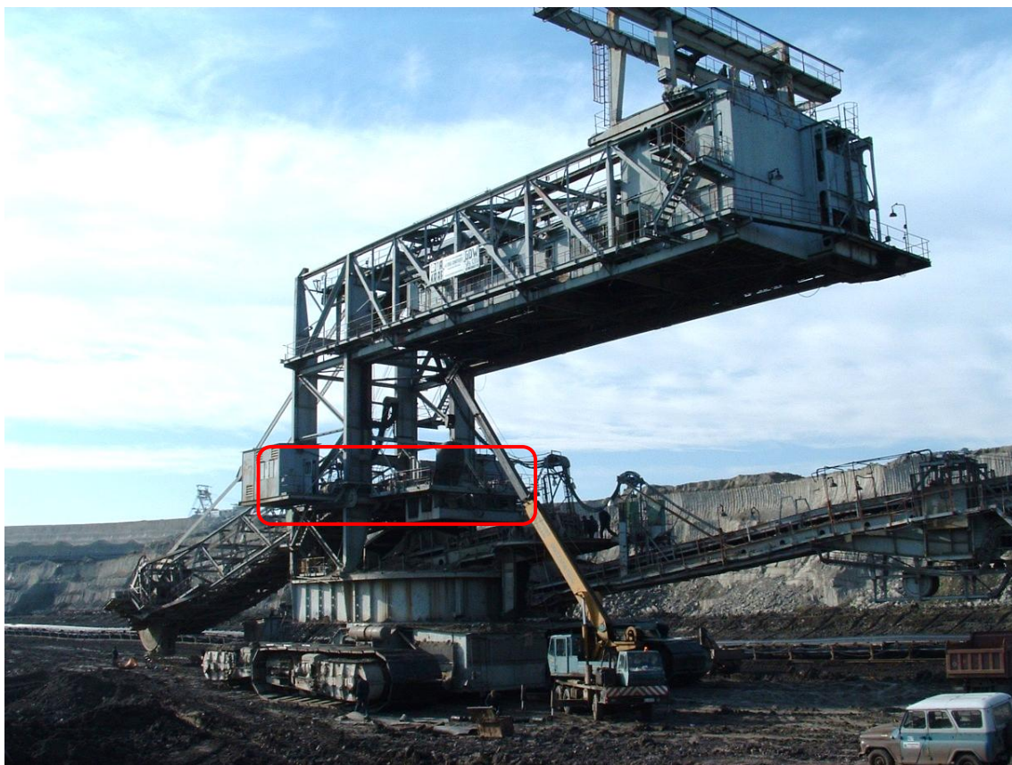
Слика 1.1 – Позиција међутранспортера на багеру SchRs 1201
