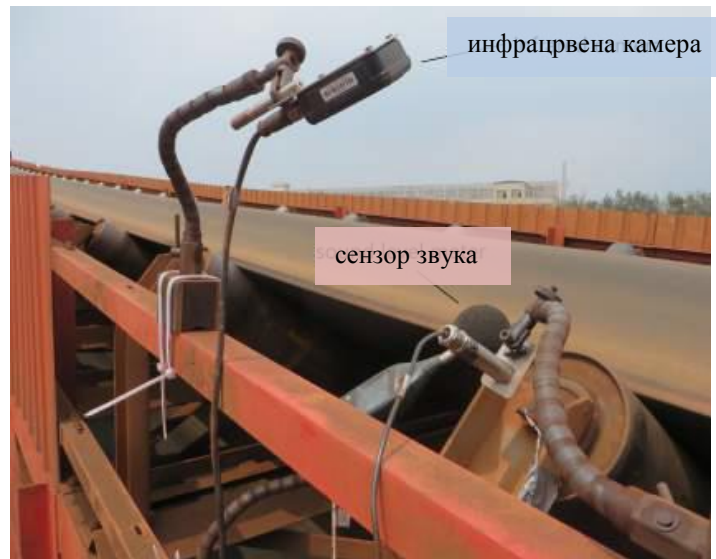
Слика 3.8: Експериментална секција транспортера на терену [15]
