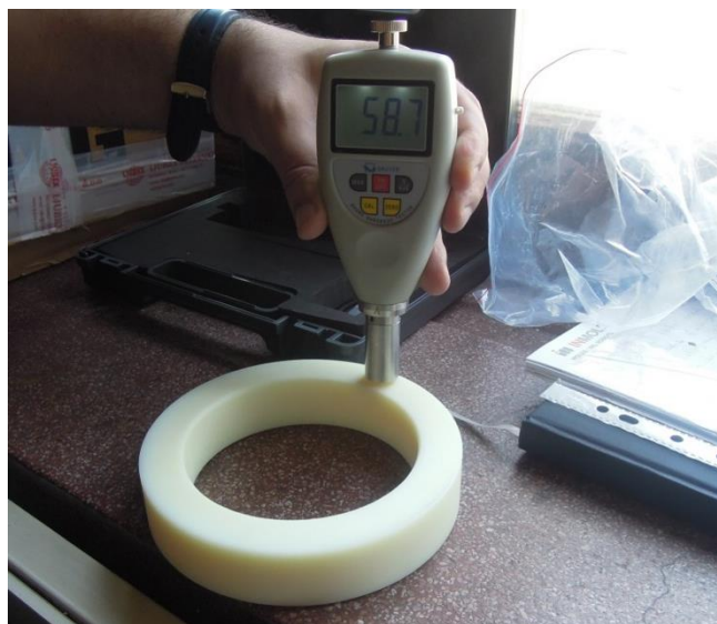
Слика 6.52: Мерење тврдоће узорака кућишта
