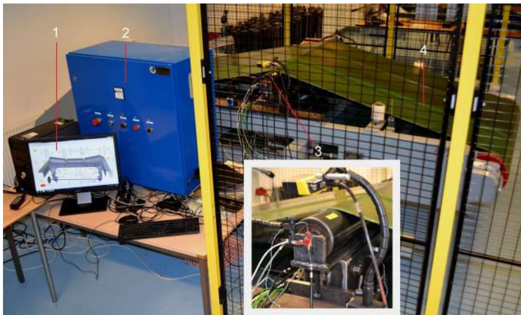
Слика 3.7: Експериментална секција транспортера у лабораторијским условима (1 - систем за аквизицију података, 2 - кутија са опремом за мерење, 3 - испитна герланда, 4 - транспортер) [15]
