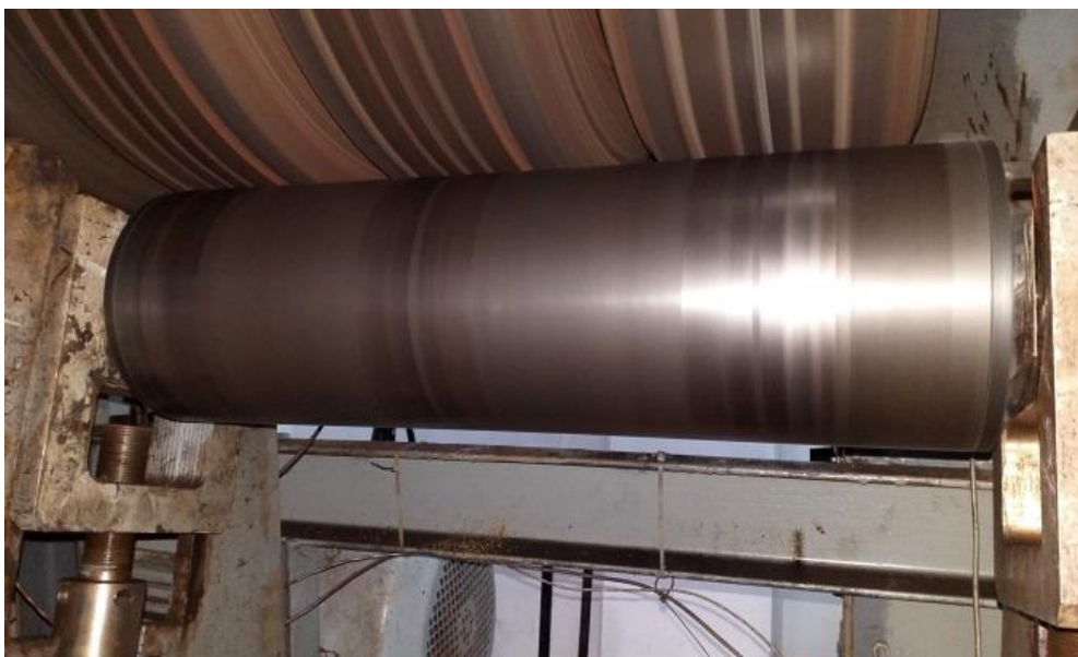
Слика 6.73: Испитивање ваљка на пробном столу за испитивање радног века и динамичке издржљивости ваљка
