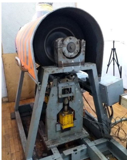
Слика 6.68: Пробни сто за испитивање радног века и динамичке издржљивости транспортних ваљка
