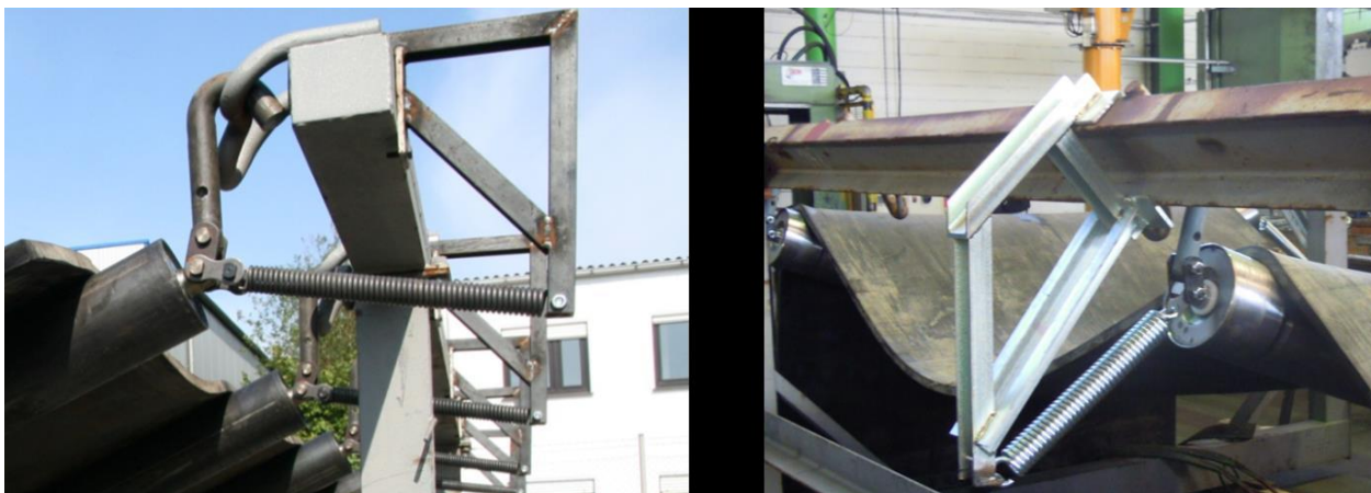
Слика 3.5: Герланда променљивог нагиба бочних ваљака [14]
