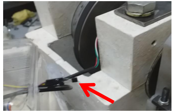
Слика 6.20: Повезивање сензора температуре околине TMP36 са микро-процесорском јединицом (лево) и место уградње сензора (десно)
