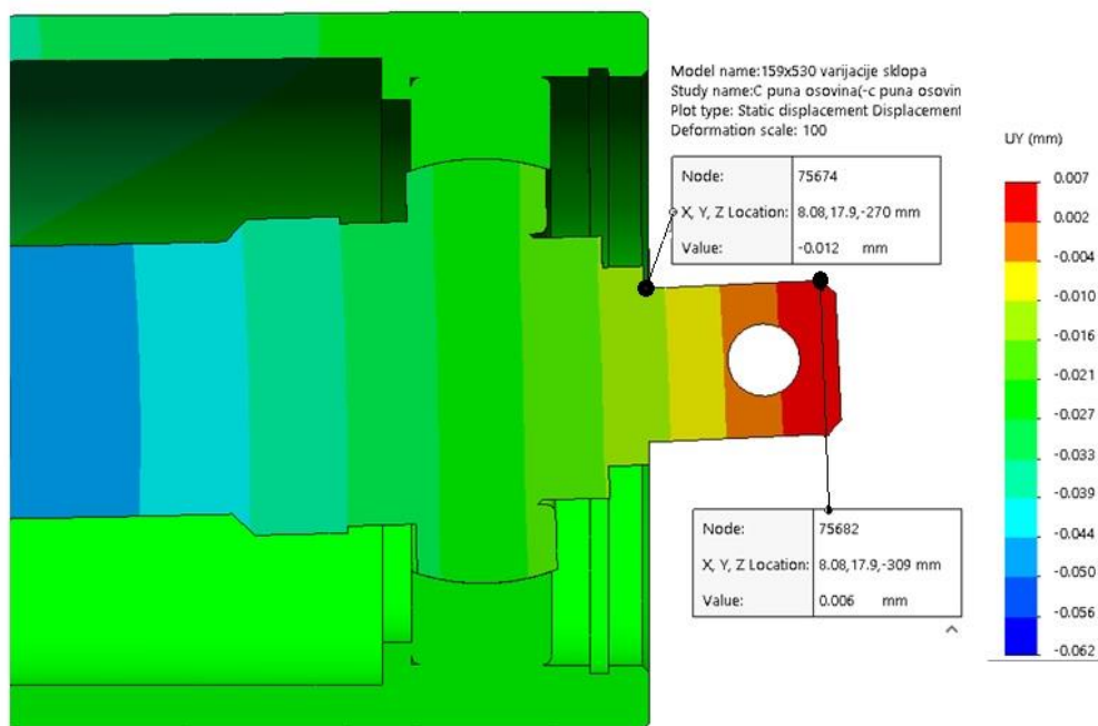
Слика 5.13: Помераји тачака по вертикалној оси тела ваљка и осовине од челика за кружни попречни пресек осовине
