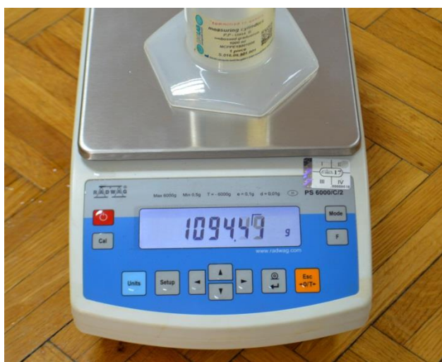
Слика 6.72: Мерење тежине течности и мензуре за ваљак са челичним кућиштем (лево) и ваљак са полимерним кућиштем (десно)
