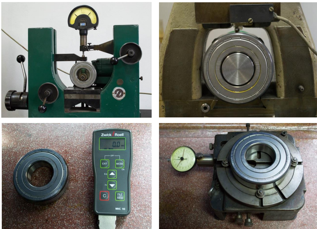
Слика 6.13: Испитивање димензија и тврдоће лежаја
