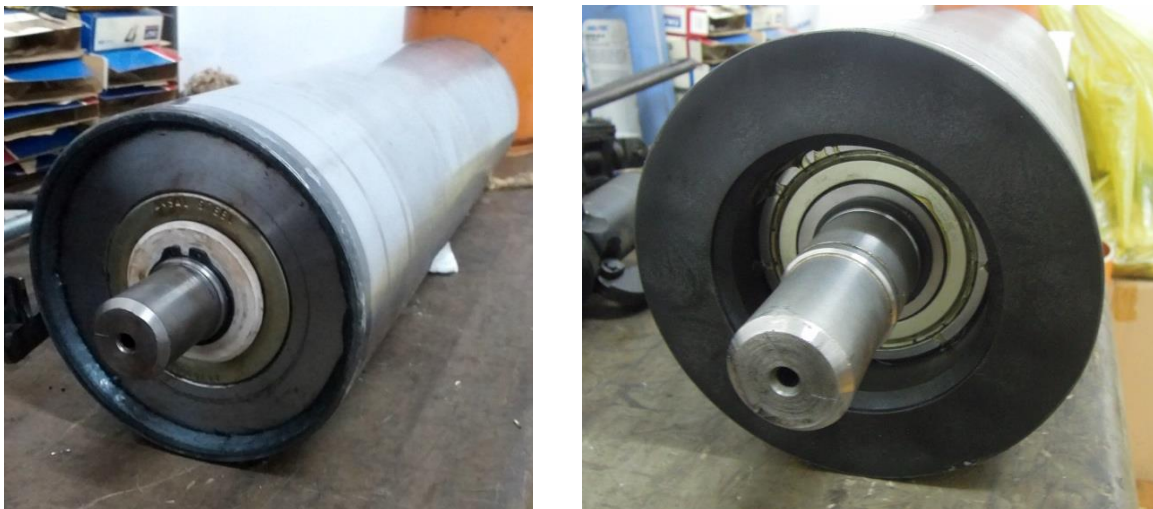
Слика 6.66: Носећи ваљци спремни за испитивање са челичним кућиштем (лево) и полимерним кућиштем (десно)
