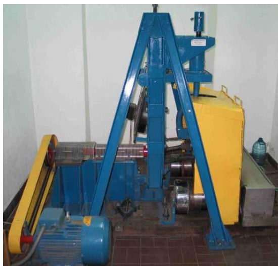
Слика 3.9: Експериментална опрема за испитивање полиуретанских ваљака [16]
