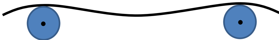
Слика 4.9: Угибање траке између две герланде
