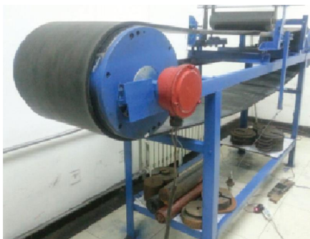
Слика 3.10: Експериментална опрема за испитивање укупног отпора котрљања ваљка [17]
