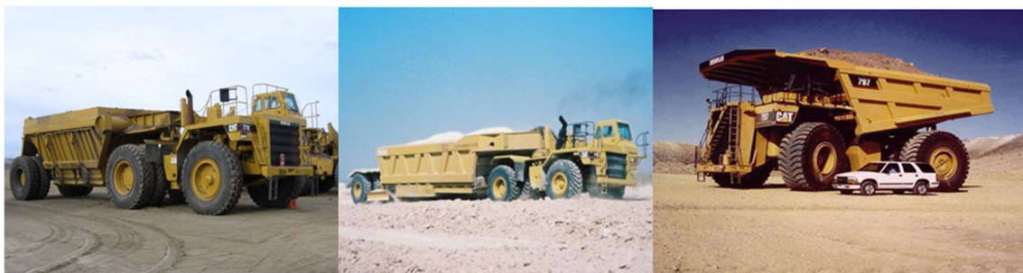
Slika 3-10 a-tegljači sa poluprikolicom, b-tegljač sa prikolicom, v-damper, preuzeto iz [53]
