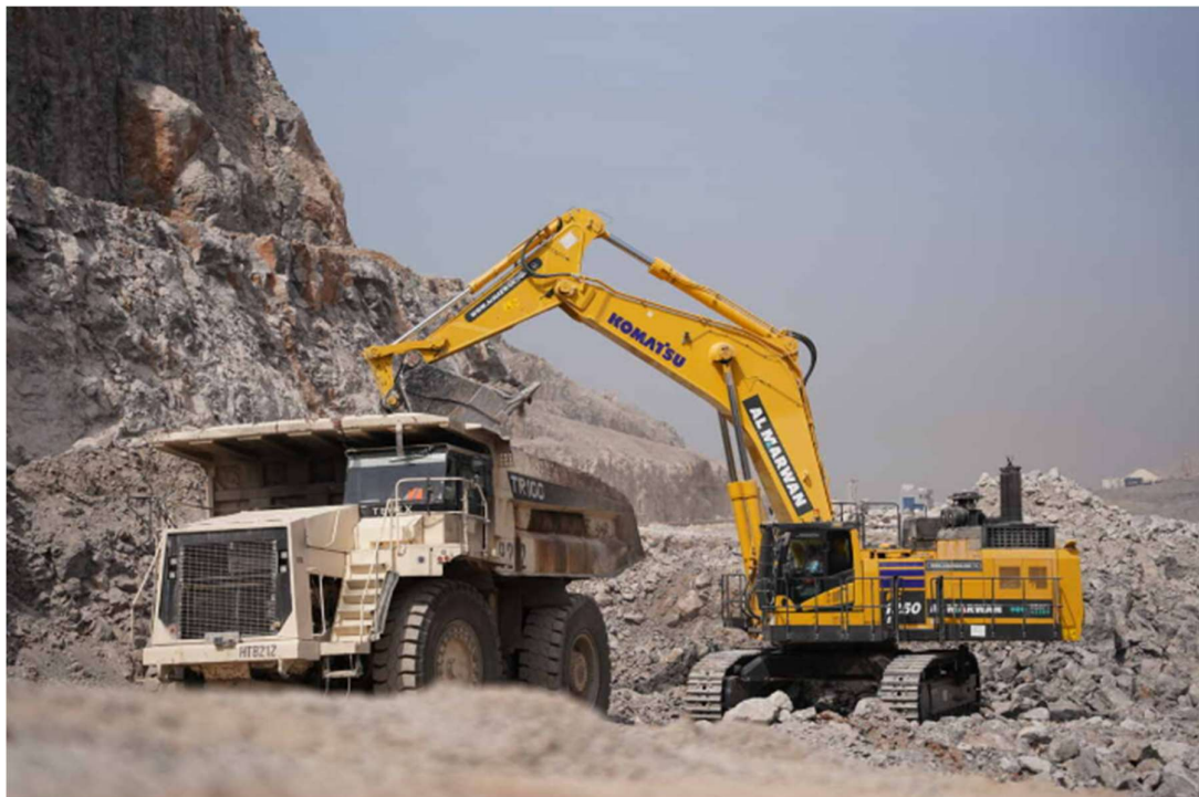
Slika 3-4 Rad bagera i transportnog sredstva u okviru utovarno-transportnog sistema na površinskom kopu., preuzeto sa [58]
