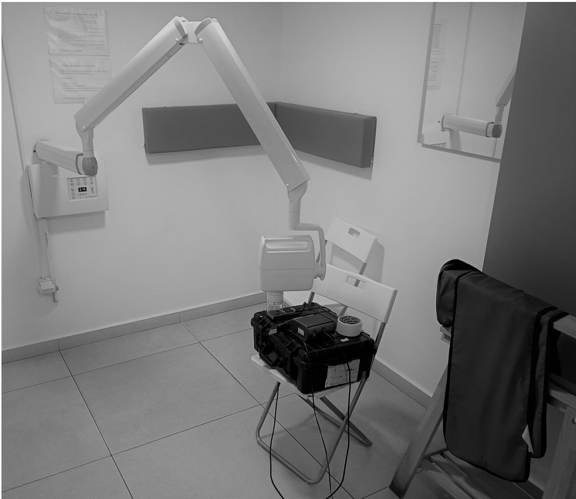
Slika 2. Postavka mernih instrumenata prilikom kontrole kvaliteta intraoralnog rendgen aparata
