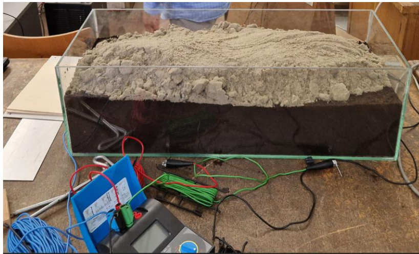
Сл. 5.21 – Почетак припреме двослојног модела тла, након што је песак из пластичне кутије пребачен преко земље у стаклени суд
