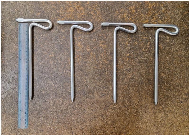
Сл. 5.10 – Алуминијумске мерне електроде које долазе уз инструмент
