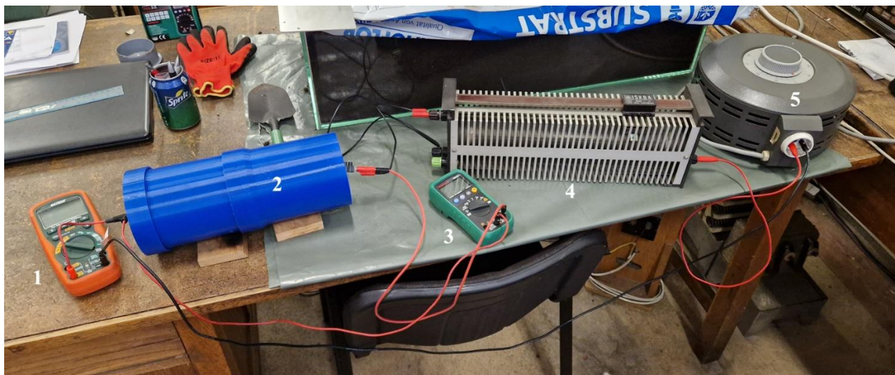
Сл. 9.4 – Мерна поставка: (1) амперметар, (2) цилиндрични суд са песком, (3) волтметар, (4) клизни отпорник и (5) аутотрансформатор
