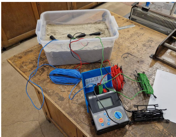
Сл. 5.15 – Мерење Венеровом методом специфичне отпорности растреситог песка у пластичној кутији, коришћењем поп-нитни као електрода, растојање између електрода a = 10 cm
