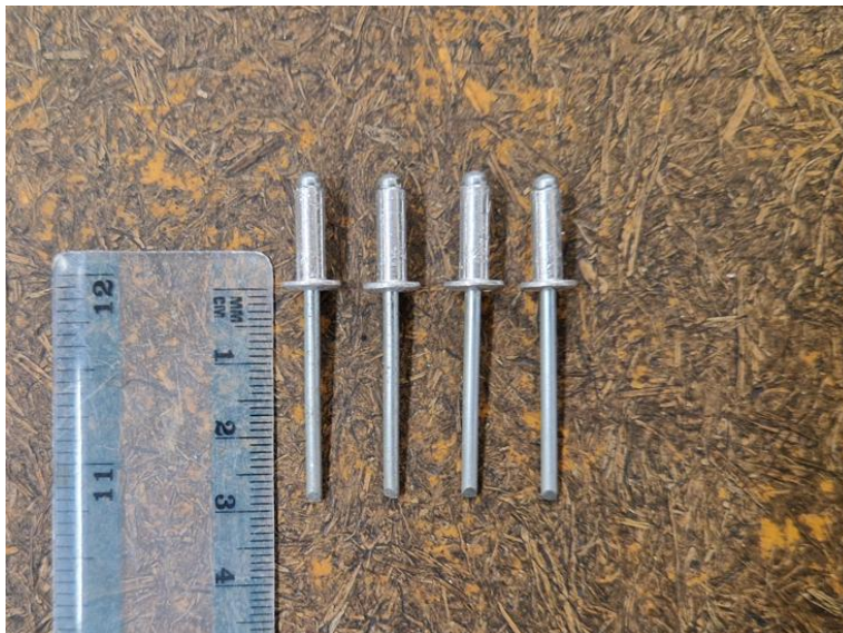
Сл. 5.9 – Поп-нитне 4x12 коришћене као електроде за мерења специфичне отпорности Венеровом методом на експерименталном лабораторијском моделу гла
