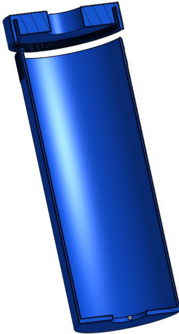
Сл. 9.3 – Изглед произведеног суда у перспективи, пресеченог на пола ради јасноће, за директно мерење специфичне отпорности појединачног медијума
