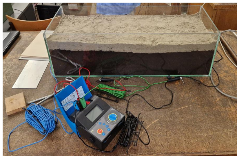
Сл. 5.22 – Изглед експерименталне поставке двослојног модела тла непосредно пре почетка мерења Венеровом методом
