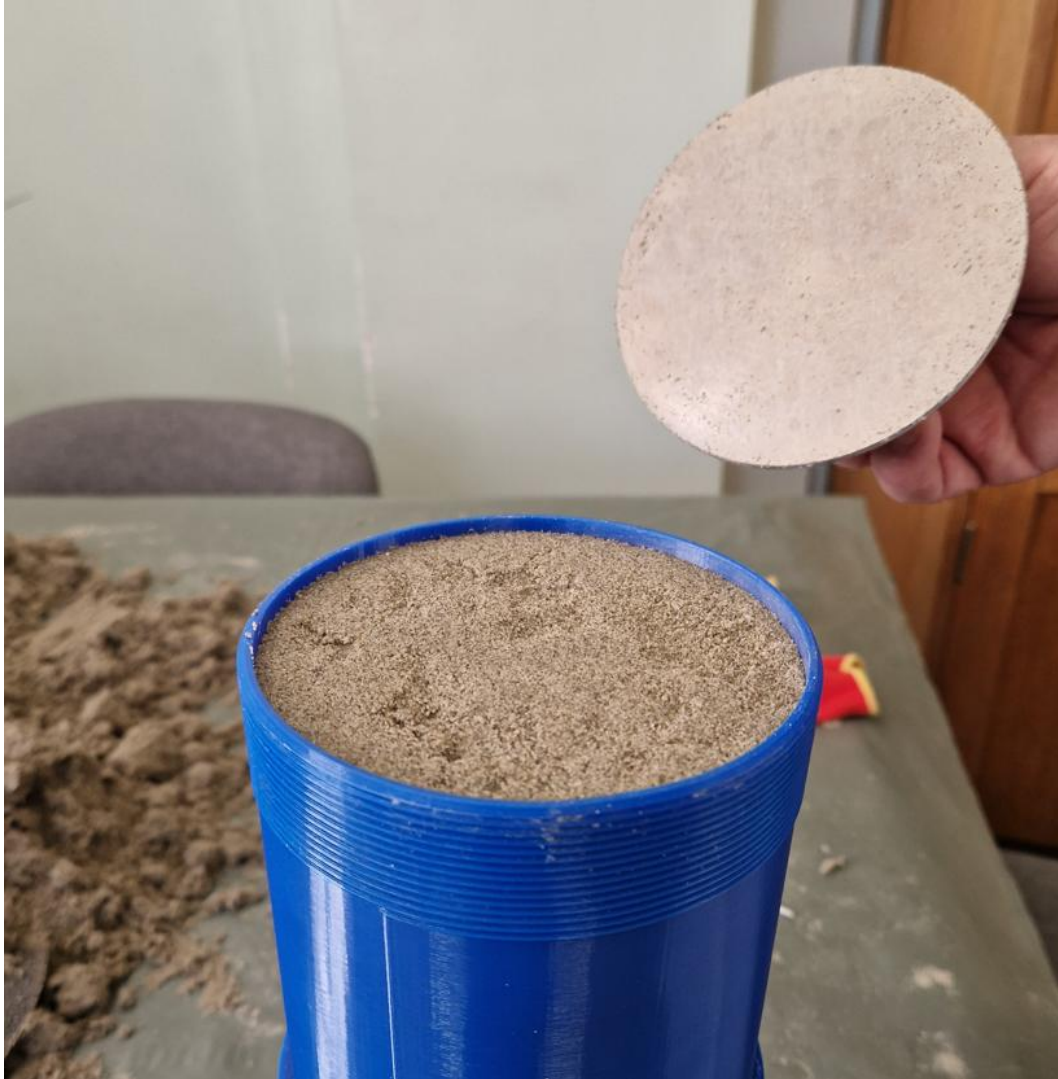
Сл. 9.1 – Изглед врха сонде напуњене песком и алуминијумске електроде која додирује медијум који се испитује
