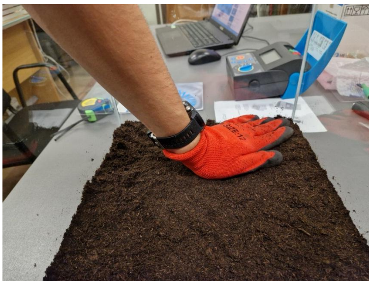
Сл. 5.5 – Набијање земље у стакленом суду између 2 наношења лопатицом
