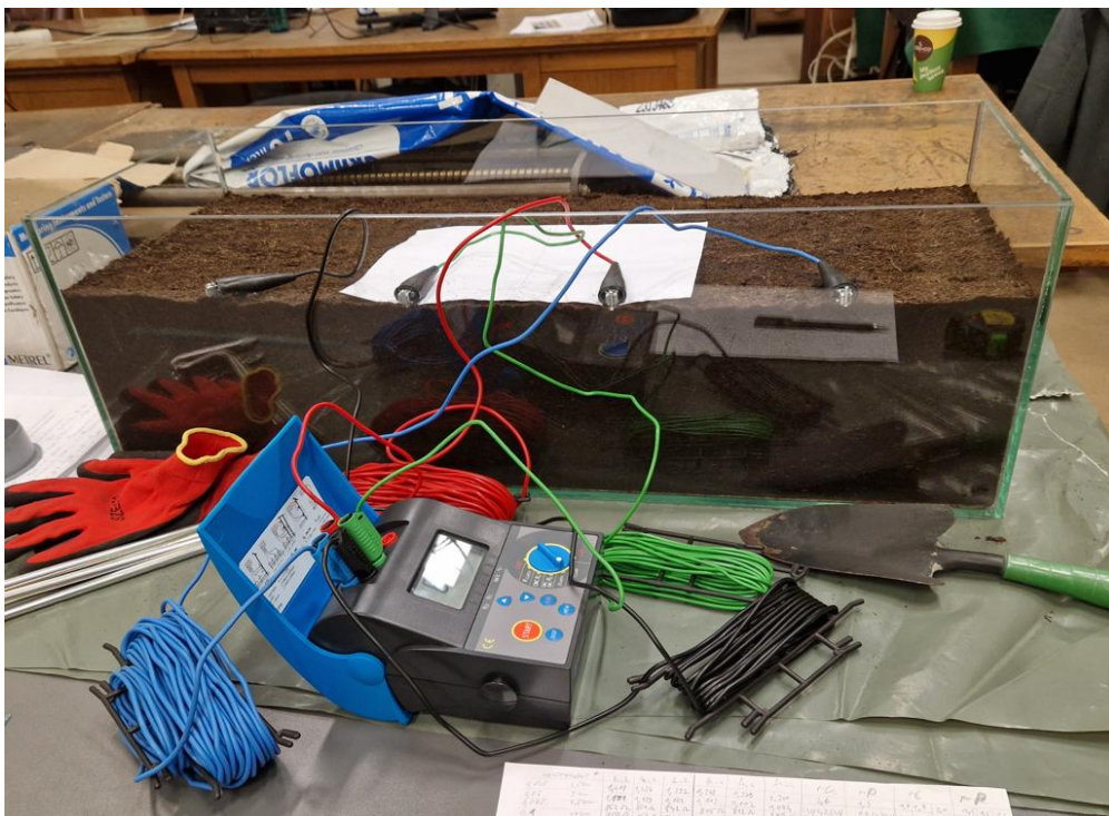
Сл. 5.14 – Мерење Венеровом методом дуж прве подужне стране стакленог суда за међусобно растојање електрода a = 20 \text{ cm}
