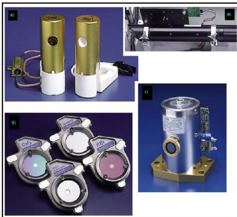
Слика 5.6. Изглед делова FTIR спектрометра а) извор, б) делилац снопа, в) ласер и г) детектор (из Јовић, 2021)
