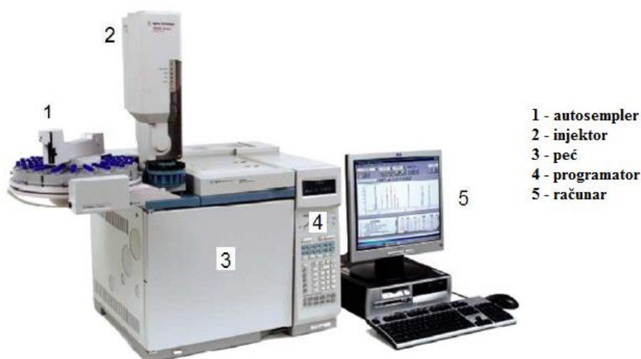
Slika 19. Izgled gasnog hromatografa (Ristić, 2019)
