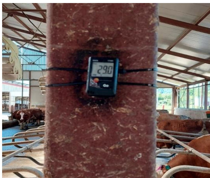
Slika 12. Beleženje ambijentalne temperature i relativne vlažnosti vazduha, korišćenjem uređaja Data logger-Testo 174H
