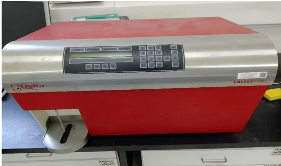
Slika 15. Uređaj za hemijsku analizu mleka-LactoScope Filter C4+
