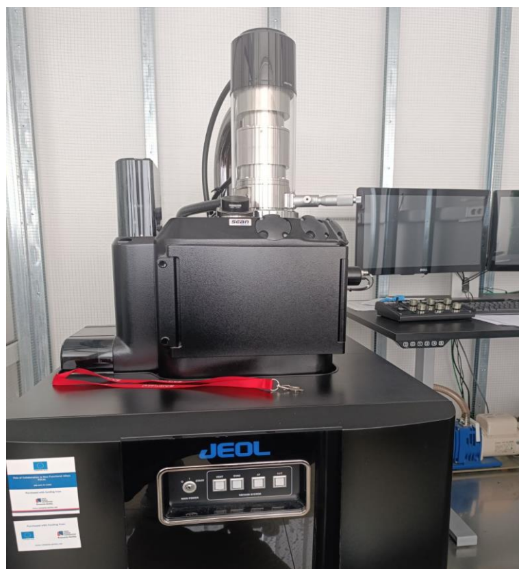
Slika 4.8. Instrument za SEM-EDS analizu JSM IT 300 LV
