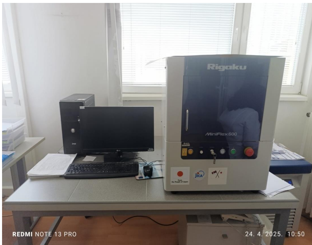
Slika 4.2 Instrumentu Rigaku MiniFlex 600 za određivanje rendgensko difrakcione analize (XRD) uzoraka
