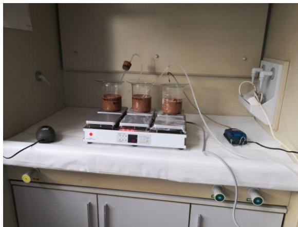
Slika 5.3. Luženje jorozit Pb-Ag taloga na magnetnoj mešalici
