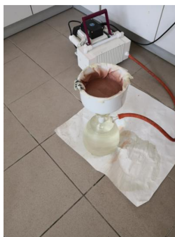
Slika 5.4. Filtriranje rastvora preko Bihnerovog levka upotrebom vakuum pumpe
