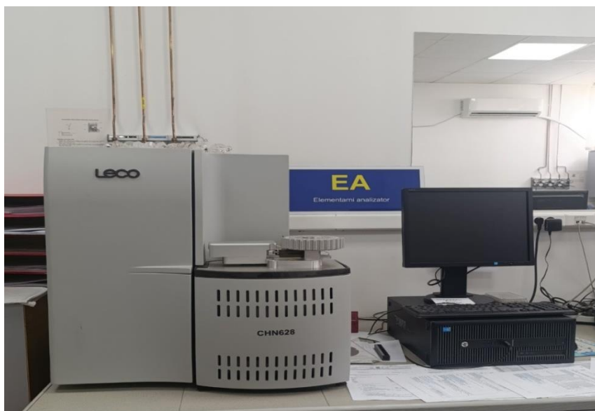
Slika 4.5. Elementarni analizator LECO CHN 628
