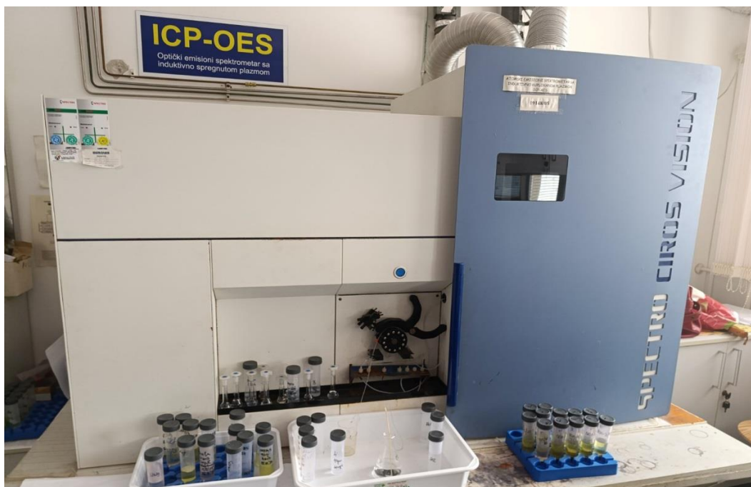
Slika 4.4. Optički emisioni spektrometar sa induktivno spregnutom plazmom
