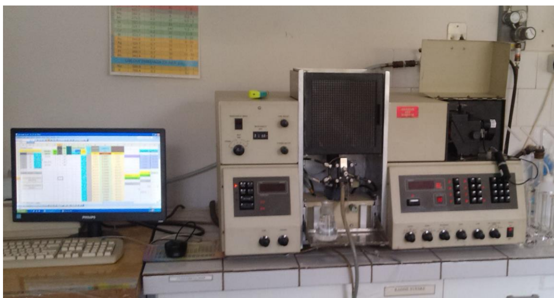
Slika 4.3. Atomski apsorpcioni spektrofotometar (Perkin-Elmer 403)
