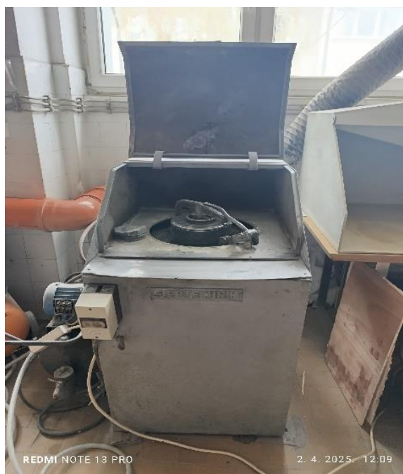
Slika 4.1 Siebtechnik vibracioni prstenasti mlin
