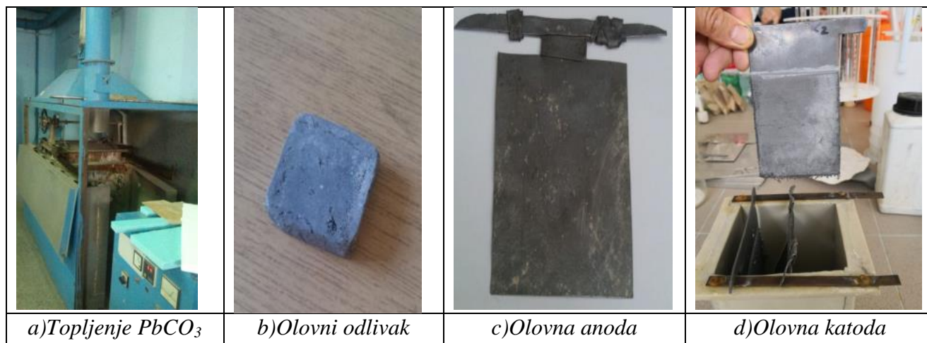
Slika 51. Topljenje olovo-karbonata i rafinacija olova: a) topljenje, b) livenje, c) pripremljena olovna anoda, d) olovna katoda
