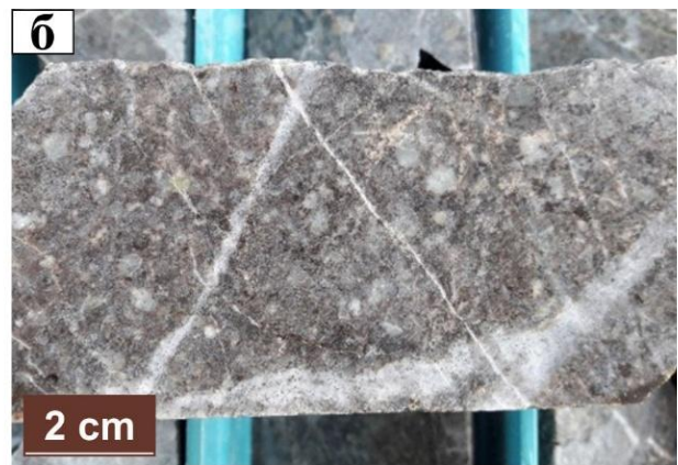
Слика 29. Макроскопски изглед крупнопорфирског плагиоклас-хорнбленда-биотитског андезит/диорит порфира Р4 серије; а - делимично хидротермално измењен и минерализован андезит/диорит порфир са јасно уочљивом примарном структуром; б - потпуно хидротермално измењен и минерализован андезит/диорит порфир са делимично видљивом примарном структуром
