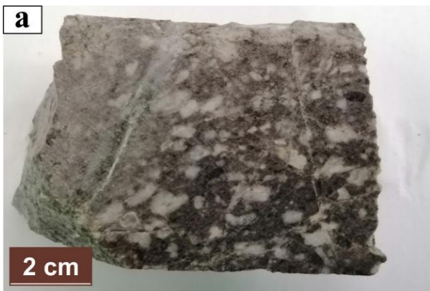
Слика 29. Макроскопски изглед крупнопорфирског плагиоклас-хорнбленда-биотитског андезит/диорит порфира Р4 серије; а - делимично хидротермално измењен и минерализован андезит/диорит порфир са јасно уочљивом примарном структуром; б - потпуно хидротермално измењен и минерализован андезит/диорит порфир са делимично видљивом примарном структуром
