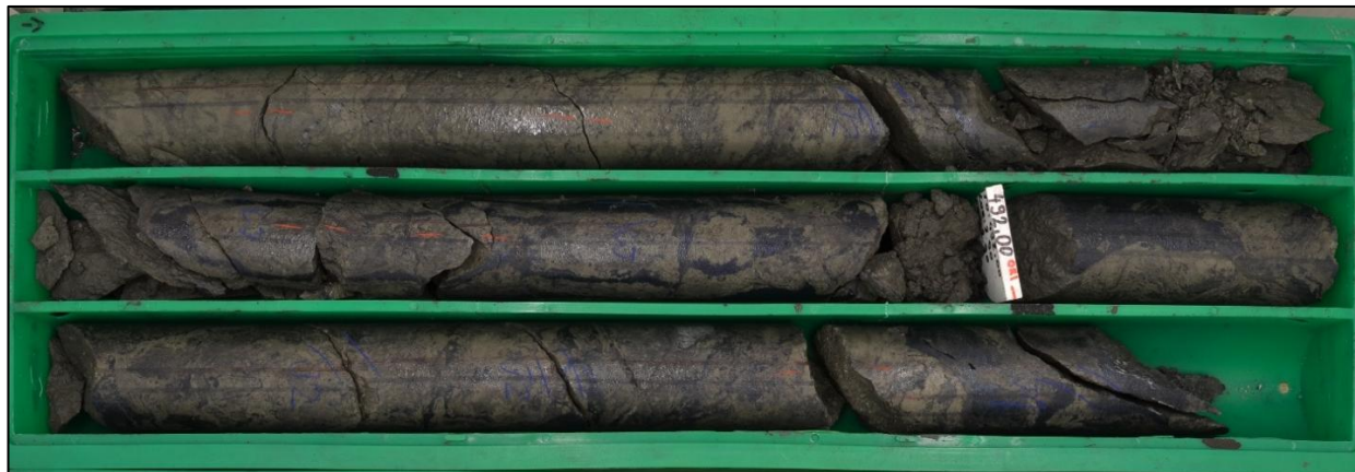
Слика 10. Пример макроскопског изгледа епитермалне минерализације масивно сулфидног типа из Рудног тела 1
