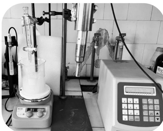
Slika 11. Aparatura za sintezu MBAG nanočestica
