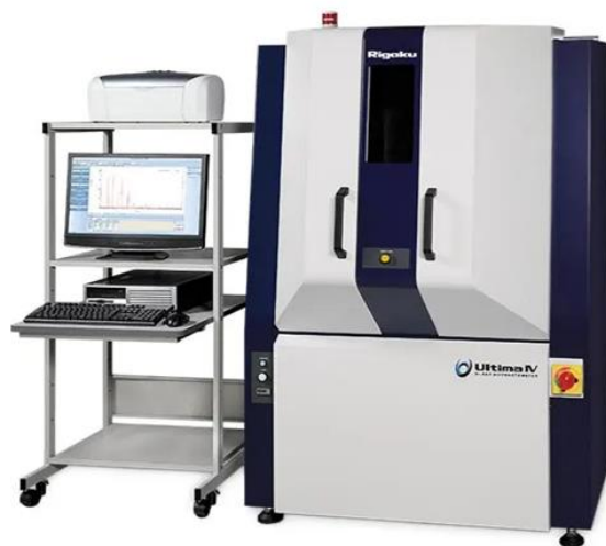
Слика 22. XRD уређај коришћен у раду [153].
