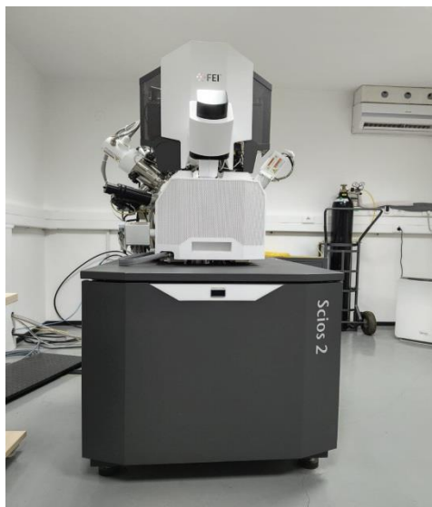
Слика 21. FESEM уређај коришћен у раду.
