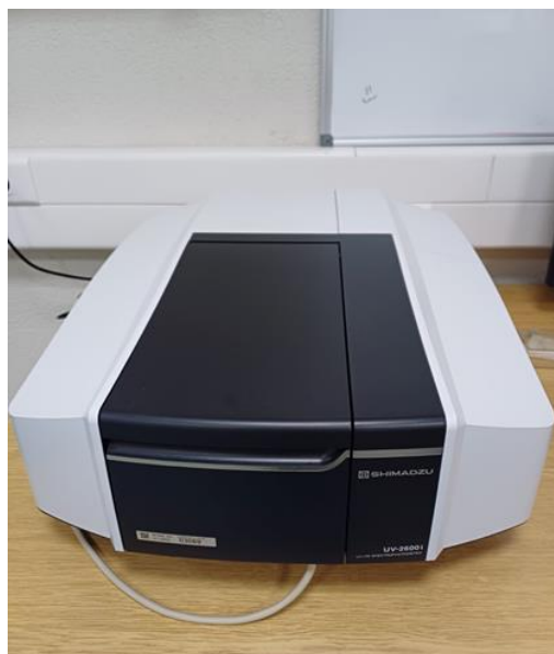
Слика 25. UV-Vis DRS уређај коришћен у раду.
