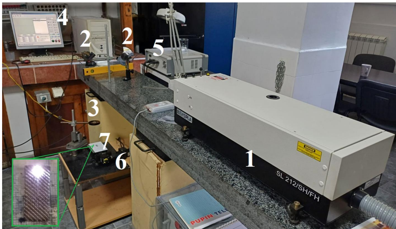
Слика 19. Експериментална поставка за озрачивање титанске мрежице.
