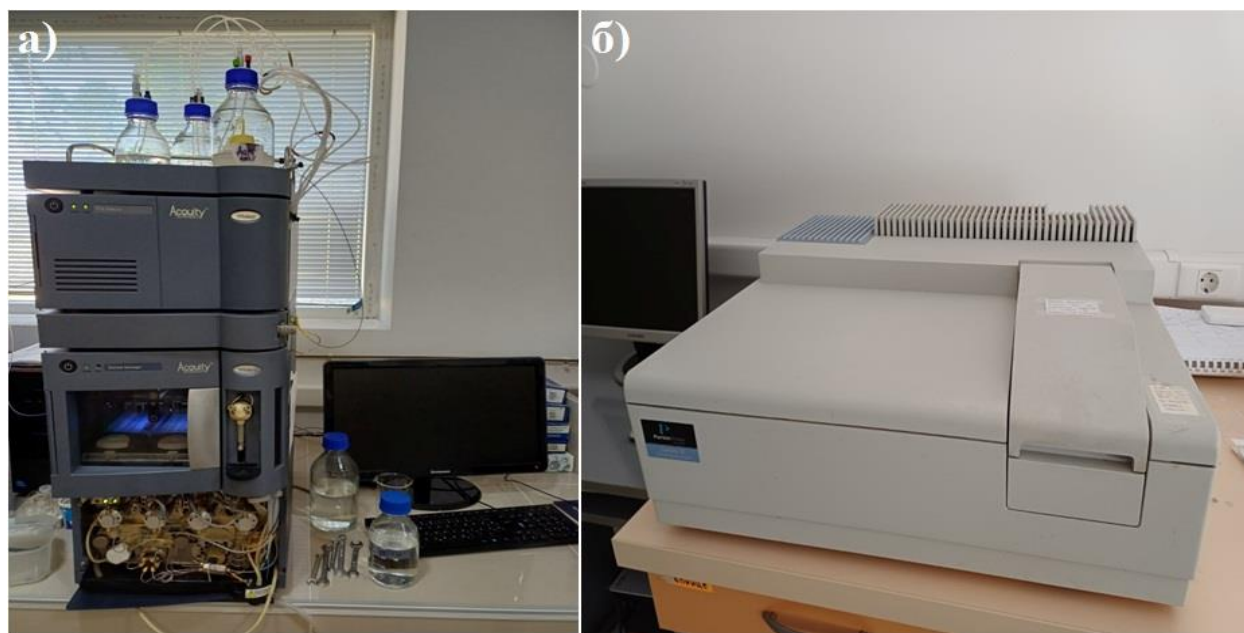
Слика 30. (а) UPLC-PDA и (б) UV-Vis уређај коришћени у раду.
