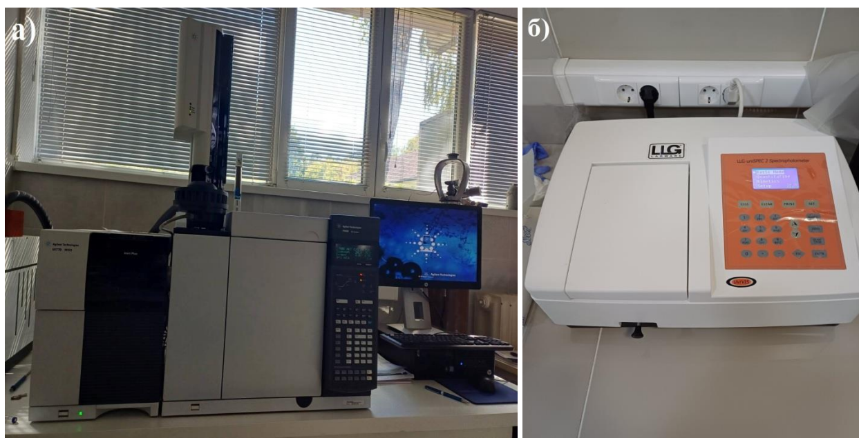
Слика 29. (а) GC-MS и (б) UV-Vis уређај коришћени у раду.
