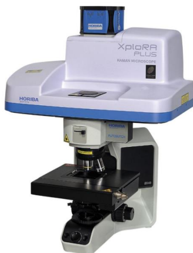
Слика 23. Раман уређај коришћен у раду [154].
