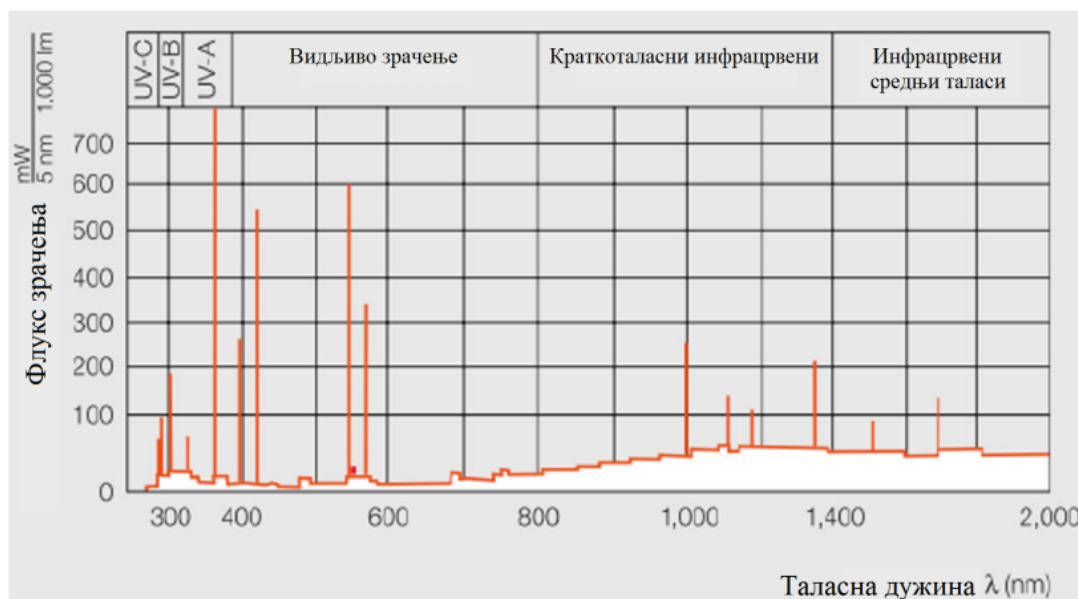
Слика 27. Спектрална расподела Osram Ultra-vitalux 300 W лампе. Прилагођено из референце [155].
