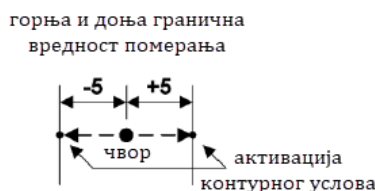
Слика 34. Контурни услов у функцији граничне вредности померања ( u mm)
