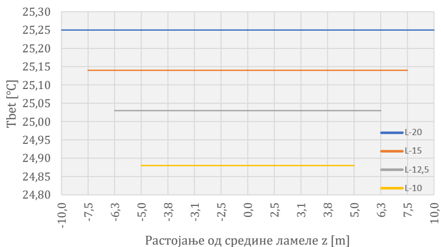
Слика 74. Температуре у бетону у средини хоризонталног пресека на 172,0 mtt (ка обалама реке) за ламеле различитих дужина (1505. дан)
