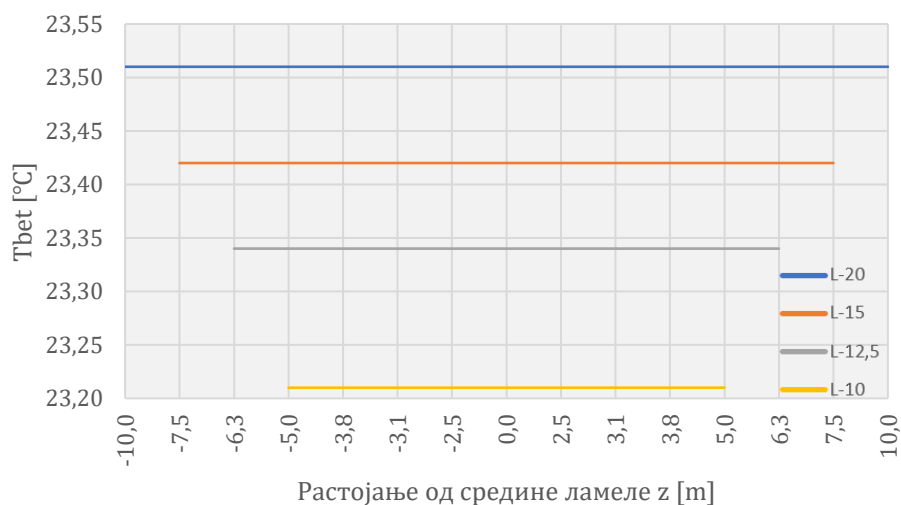
Слика 77. Температуре у бетону у средини хоризонталног пресека на 170,50 mtt (ка обалама реке) за ламеле различитих дужина (1804. дан)
