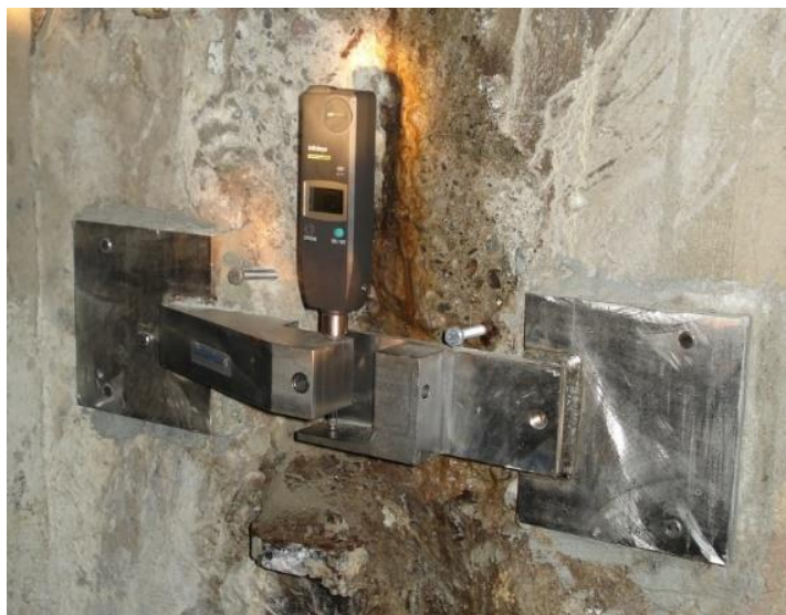
Слика 14. Компаратер постављен на мерне ослоње (у положају за мерење вертикалног смицања) [82]
