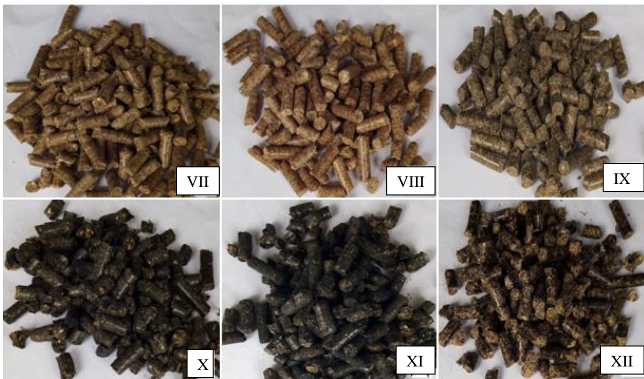
Слика 17. Приказ простирки пелетиране формулације. (VII) Пелетирана пшенична слама. (VIII) Дрвени пелет од хобловине. (IX) Пелет од мешавине пшеничне сламе (90%) и зеолита (10%). (X) Пелет од мешавине пшеничне сламе (90%) и дрвеног угља (10%). (XI) Пелет од мешавине пшеничне сламе (80%), зеолита (10%) и дрвеног угља (10%). (XII) Пелет од мешавине пшеничне сламе (1/3), хобловине (1/3) и тресета (1/3).
