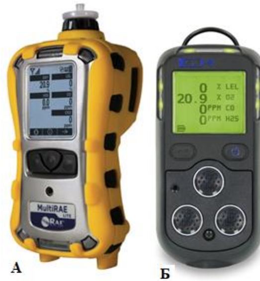
Слика 12. Преносни инструменти за мерење концентрација штетних гасова: (А) MultiRAE Lite PGM-6208; (Б) PS200 MultiGas Detector.
