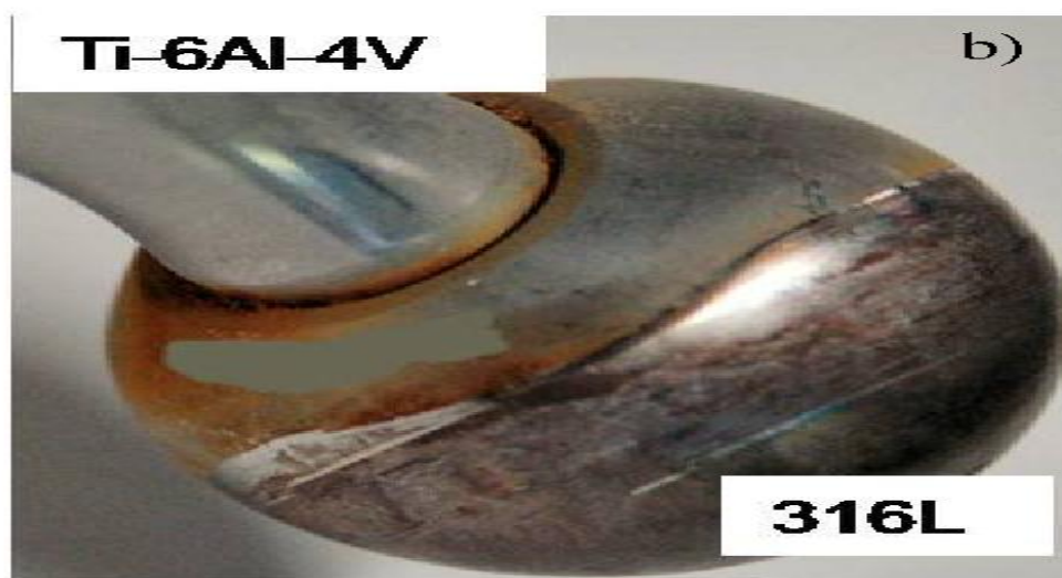
Slika 2.3. Korozija veštačkog kuka [12]
