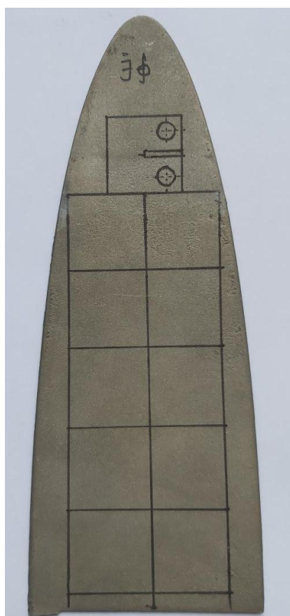
Slika 5.2. Uzorak legure titanijuma iz kojeg su izrađene CT epruvete za potrebe eksperimentalnog određivanja parametara mehanike loma
