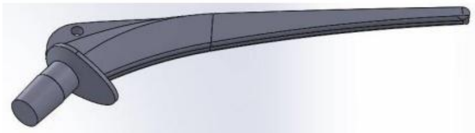
Slika 6.2. Model veštačkog kuka dobijen u SolidWorks softveru na osnovu 3D skena fizičkog kuka [73]
