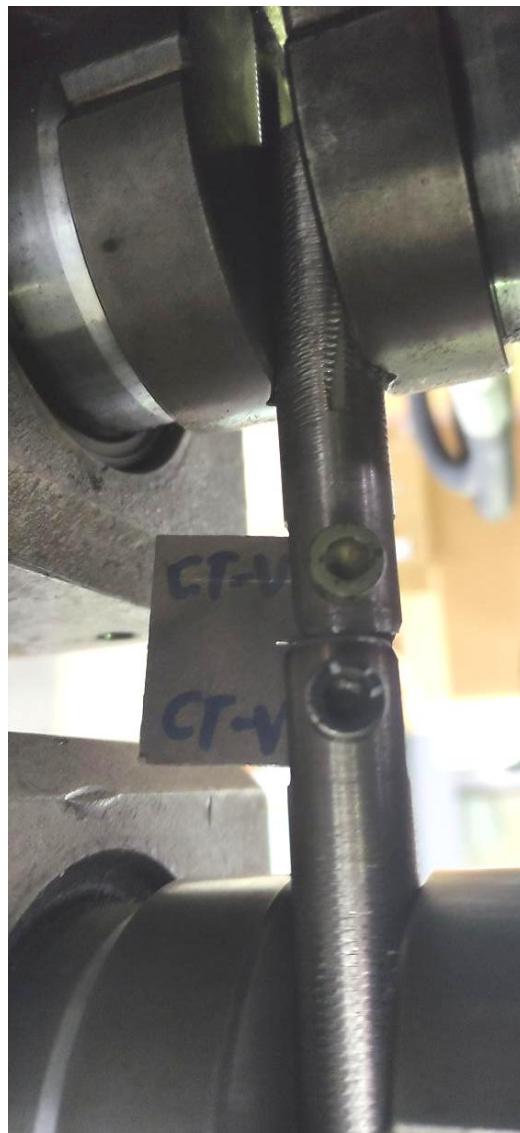
Slika 5.14. Epruveta iz treće grupe (vlažna sredina), postavljena u čeljusti INSTRON kidalice
