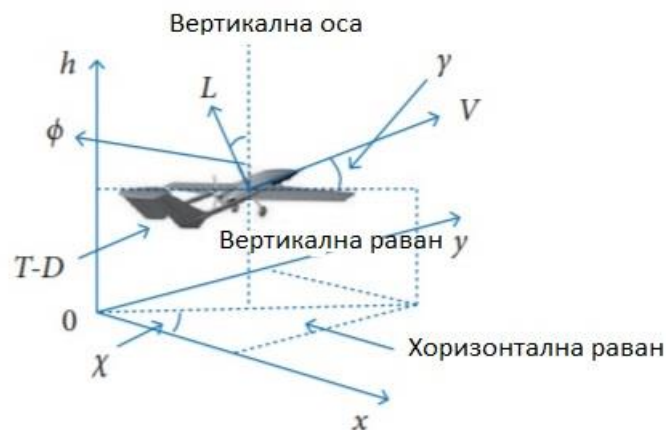
Слика 1: Беспилотна летелица у троосном координатном систему
