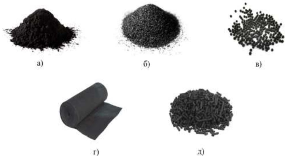
Слика 1. Облици активних угљеничних материјала: а) прашкасти, б) гранулисани, в) сферни, г) влакнасти и д) цилиндрични.
