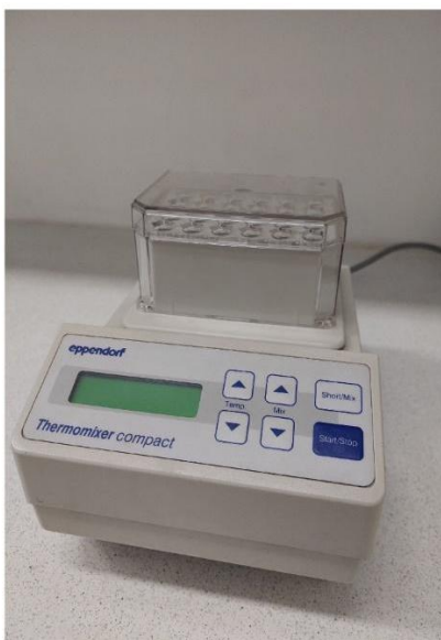
2. Rotirajuće vodeno kupatilo - Thermomixer compact (Eppendorf™)
