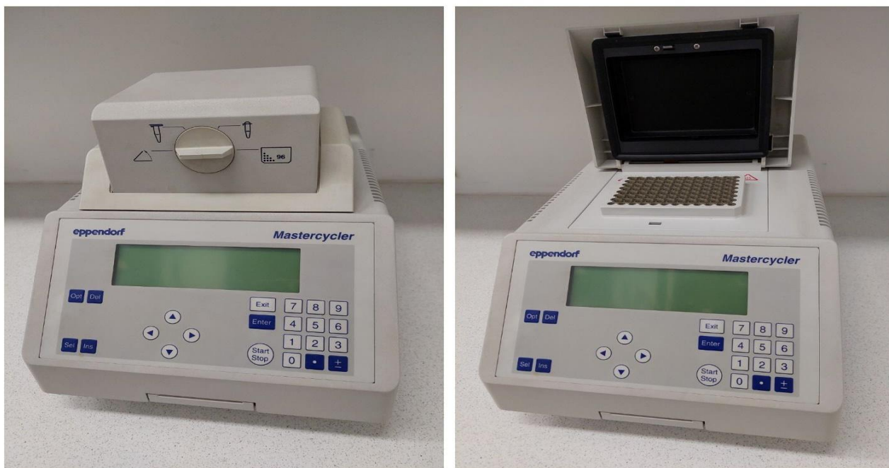
Slika 14. Eppendorf 5333 MasterCycler Thermal Cycler na kome je vršena PCR detekcija patogena.
