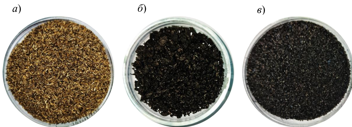
Слика 15. а) сунцокретов агроиндустријски отпад б) карбонизовани угљенични материјал в) узорак активираниог угљеничног материјала 1:3
