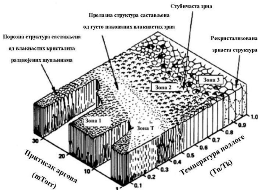
Слика 2.6. Структурне зоне континуалног танког слоја у зависности од парцијалног притиска радног гаса у комори (аргона) и односа температуре подлоге и тачке кључања метала који се депонује ( T_n/T_k ) [40].
