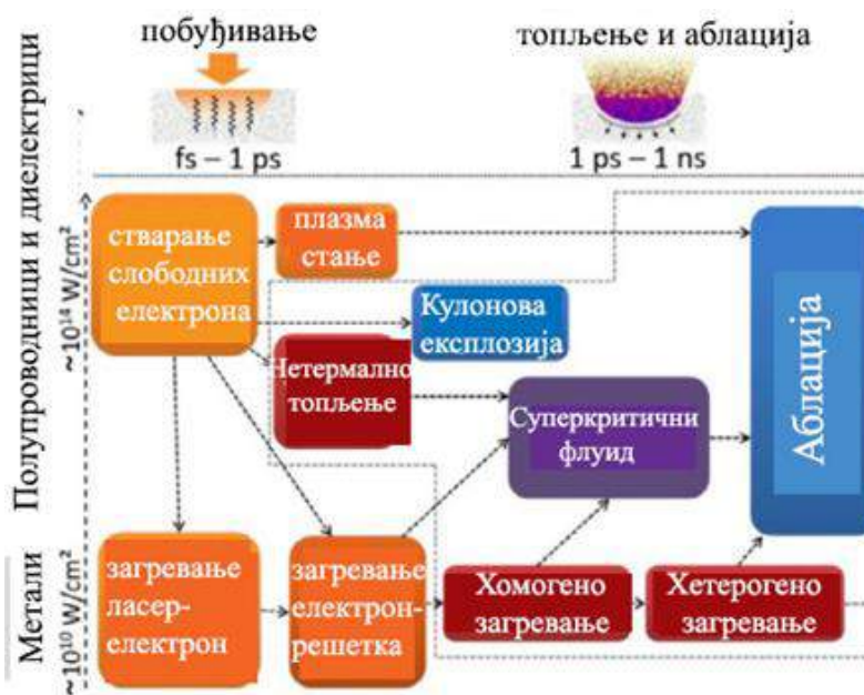
Слика 2.14. Шематски приказ физичких феномена и временских оквира ултра-брзе ласерске модификације метала, полупроводника и диелектрика [69].
