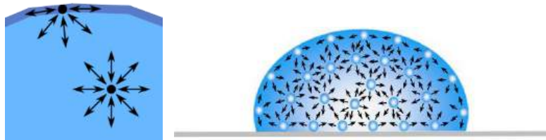
Слика 2.9. а) Приказ деловања еластичних сила на молекуле течности на површини и у њеној унутрашњости; б) Формирање капи течности услед деловања површинског напона течности.
