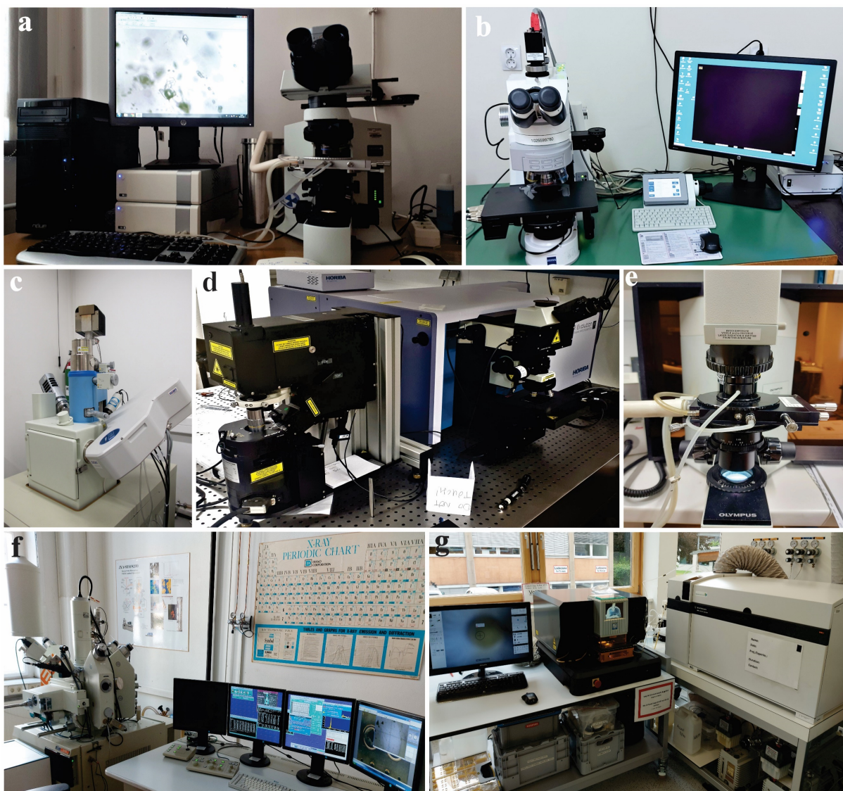
Slika 7. a) Mikroskop Olympus BX51 u Laboratoriji za ispitivanje fluidnih inkluzija RGF-a. b) Mikroskop „Zeiss“ Axio Imager 2 u Laboratoriji za istraživanje mineralnih sirovina RGF-a. c) SEM tipa JEOL JSM-6610LV u Laboratoriji za SEM RGF-a. d) Mikro-Raman spektrometar tipa LabRAM HR Evolution kompanije HORIBA Jobin Yvon u Laboratoriji Raman-TERS-AFM na UL. e) Mobilni instrument Linkam THMSG povezan sa Raman uređajem u Laboratoriji Raman-TERS-AFM na UL. f) Instrument JEOL JKSA-8200 u Laboratoriji za EMPA na UL. g) Maseni spektrometar Agilent 8800 povezan sa ESI NWR213 Nd:YAG sistemom za lasersku ablaciju u laboratoriji za LA-ICP-MS na UL.
