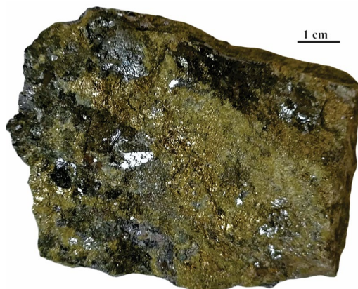
Slika 52. Rudna mineralizacija galenita, sfalerita i halkopirita iz rudnog tela GP u izmenjenoj klastičnoj jedinici.
