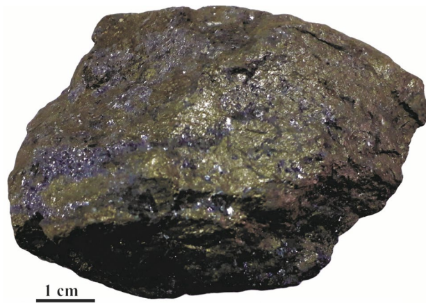
Slika 37. Masivna rudna mineralizacija pirofina, halkopirita i galenita iz grupe rudnih tela Nova Jama.
