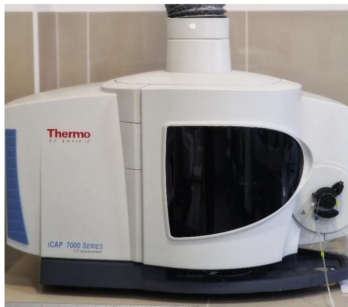
Слика 17. ICP-OES Thermo Scientific iCap 7400 duo инструмент коришћен у овој докторској дисертацији за одређивање концентрације метала
