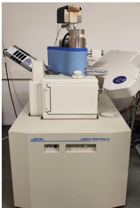
Слика 16. SEM-EDS инструмент JSM-6610LV, JEOL Токуо Јарап коришћен за анализе у овој докторској дисертацији
