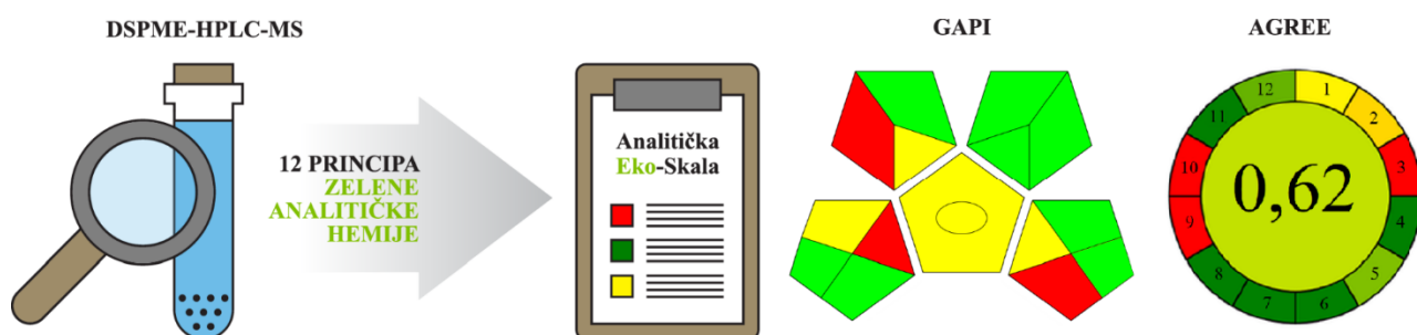
Shema 4.6. Metodologija ispitivanja zelenosti razvijene DSPME metode na MIP-peha kao čvrstoj fazi.
