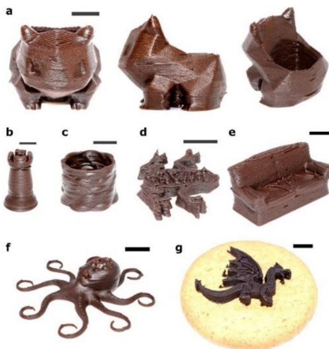
Slika 4. Uzorci na bazi čokolade štampani SSE 3D štampom (preuzeto iz reference Karyappa i Hashimoto, 2019)
