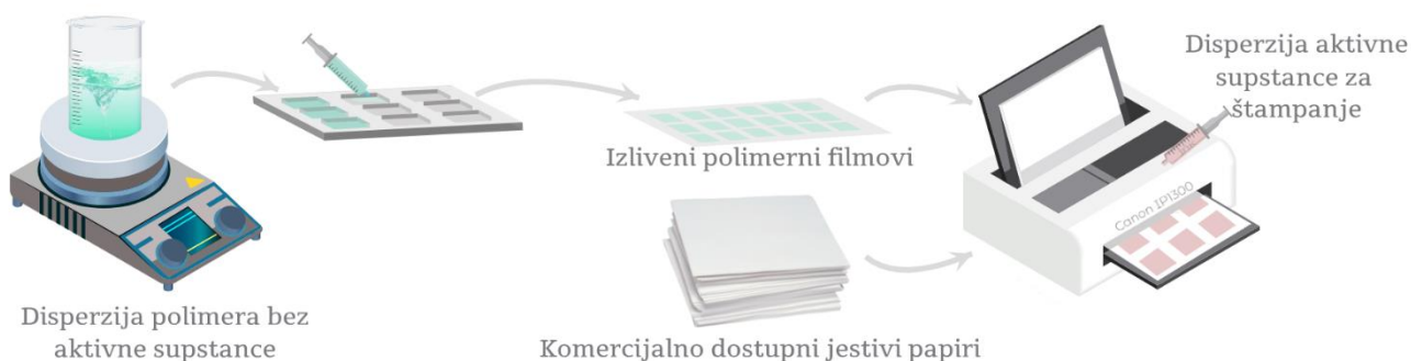
Slika 11. Ilustrovani prikaz procesa 2D štampanja
