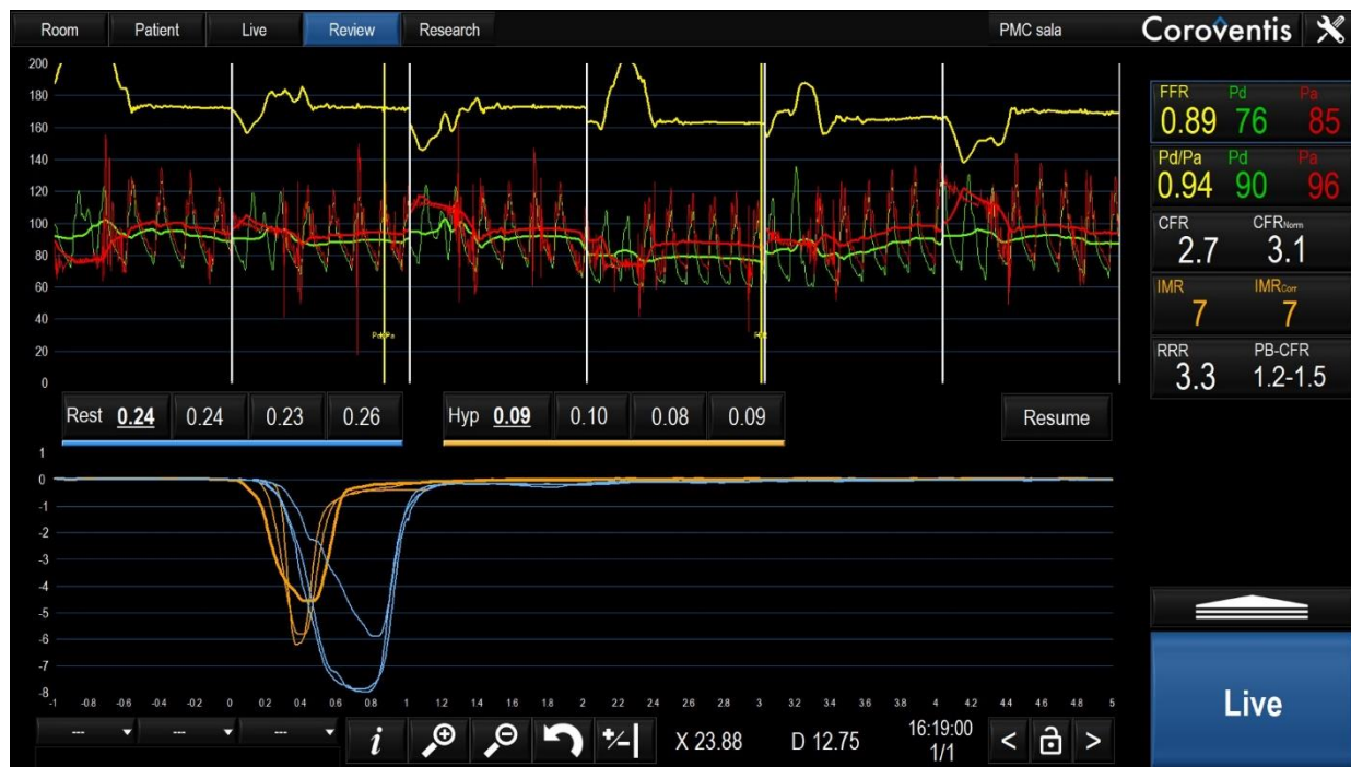
Slika 1.8. Prikaz zapisa intrakoronarne evaluacije brzine protoka indirektnom, termodilucionom metodom, sa procenom vremena koje protekne do promene temperature između proksimalnog i distalnog senzora (Tmn, engl. mean transit time ). Plava kriva u donjem polju slike označava pad temperature na mestu distalnog senzora (y-osa) nakon ubrigavanja 3 mililitra fiziološkog rastvora u bazalnim uslovima, dok narandžasta kriva označava promenu u temperaturi tokom hiperemije. X-osa predstavlja vreme proteklo do pada temperature, a kraće vreme (Tmn) u hiperemiji, u kontekstu inverzne proporcionalnosti sa brzinom protoka, označava veću brzinu koronarnog protka u hiperemiji. Crvena (aorta) i zelena (distalni deo koronarne aterije) kriva u gornjem polju slike, predstavljaju simultano merenje pritiska, čije vrednosti, zajedno sa vrednostima Tmn služe da se izračuna FFR, CFR i HMR (vrednosti su prikazane u desnom gornjem uglu slike).
