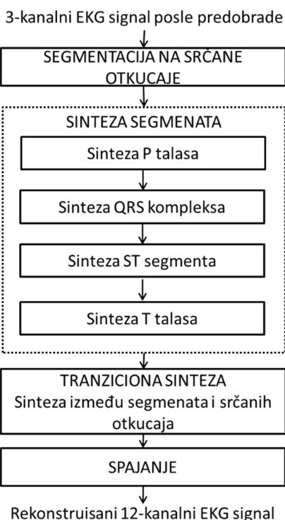
Slika 3.6. Blok diajagram algoritma za sintezu 12-kanalnog EKG signala korišćenjem metode 4 matrice.
