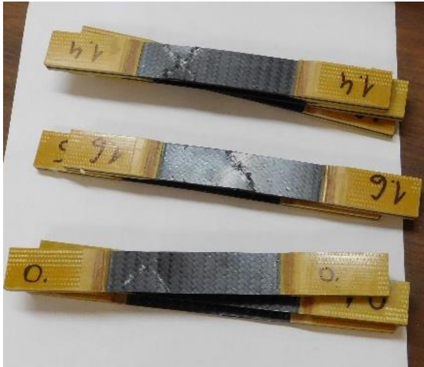
Слика 9.7 Појава отказа на узорцима, након дејства максималног оптерећења.
