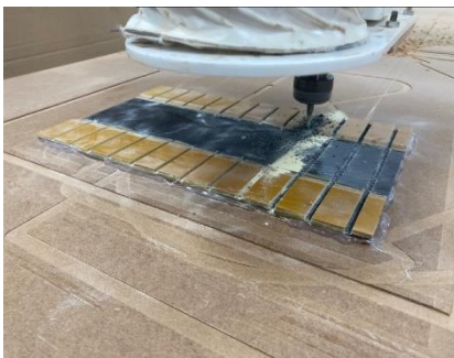
Слика 9.6 а) Израда епрувета б) Изглед епрувете за ново слагање в) Поставка експеримента на машини за испитивање
