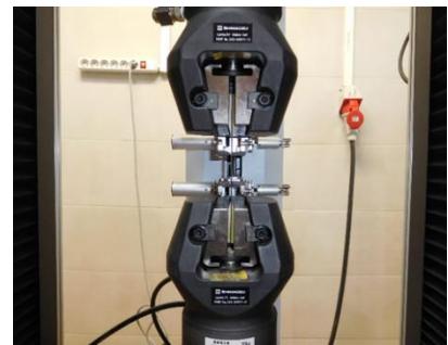
Слика 9.6 а) Израда епрувета б) Изглед епрувете за ново слагање в) Поставка експеримента на машини за испитивање
