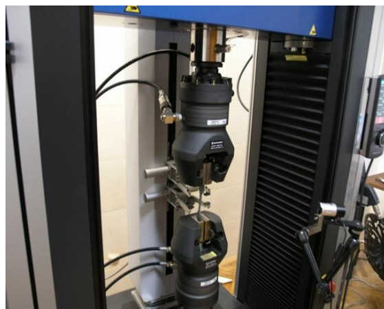
Слика 7.3 а) Епрувете, исечене из оштећене структуре б) Поставка епрувета на машини за испитивање затезања SHIMADZU AGX-V
