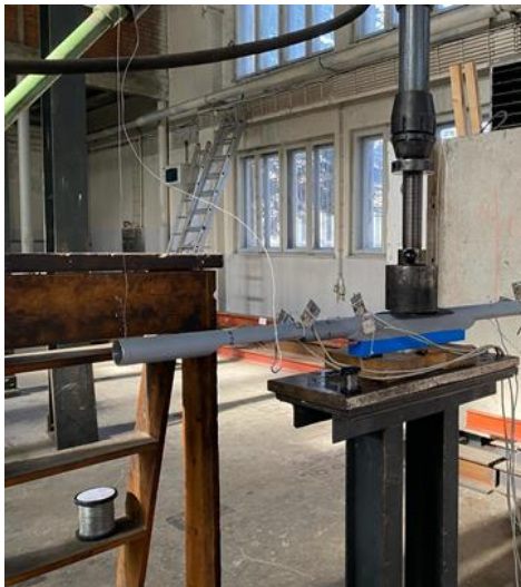
Слика 10.4 Експериментална поставка греде
