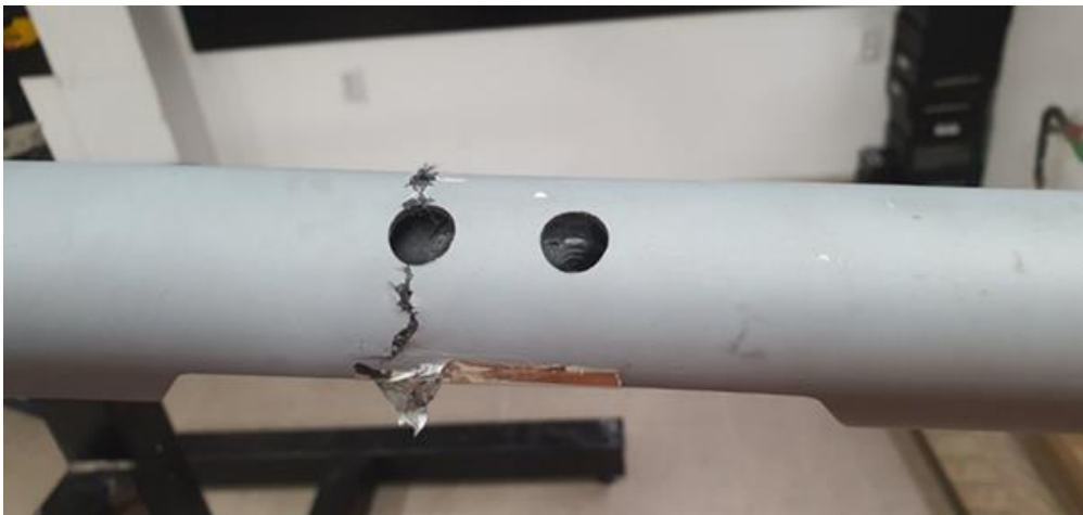
Слика 7.8 Оштећена структура греде
