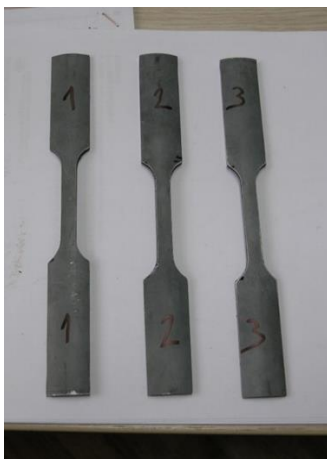
Слика 7.3 а) Епрувете, исечене из оштећене структуре б) Поставка епрувета на машини за испитивање затезања SHIMADZU AGX-V
