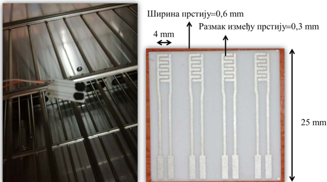
Слика 15. (а) Штампане PdAg електроде на алуминијум-оксиду са нанесеним дебелим филмом узорка и (б) димензије штампаних електрода
