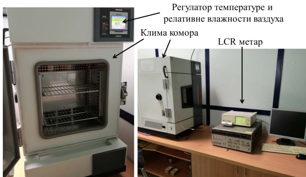
Слика 16. Клима комора (лево), експериментална поставка и уређај за мерење импедансе (десно)
