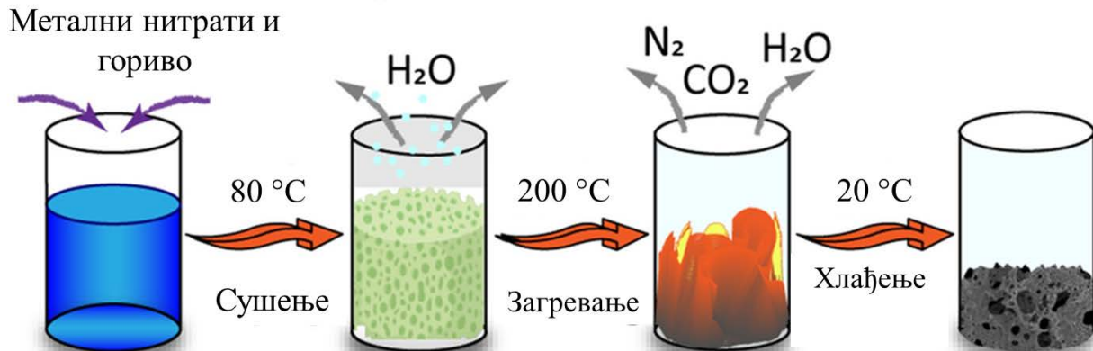
Слика 3. Типична схема сол-гел синтезе са сагоревањем. Прилагођено из рада 40
