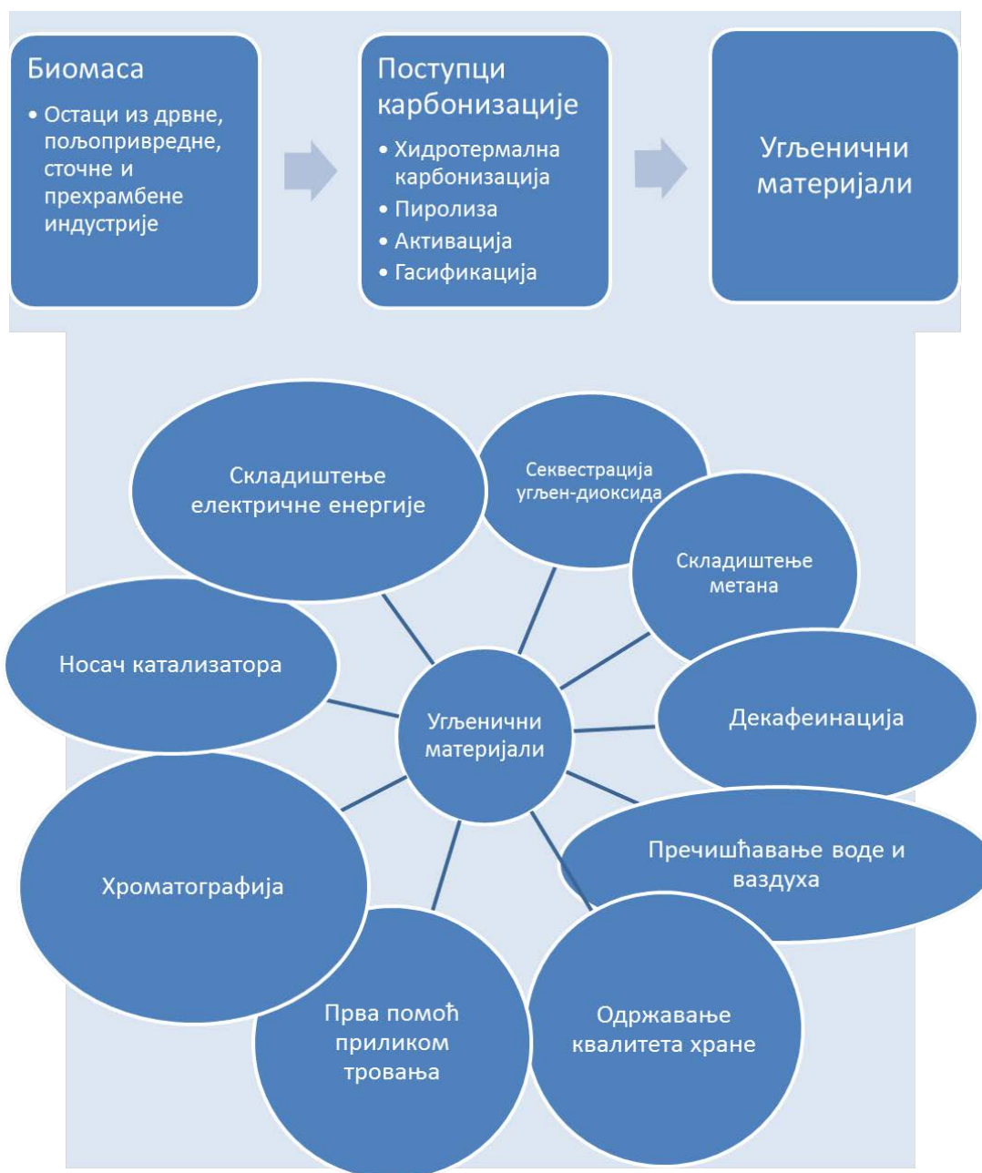
Слика 5. Схема синтезе и примене угљеничних материјала
