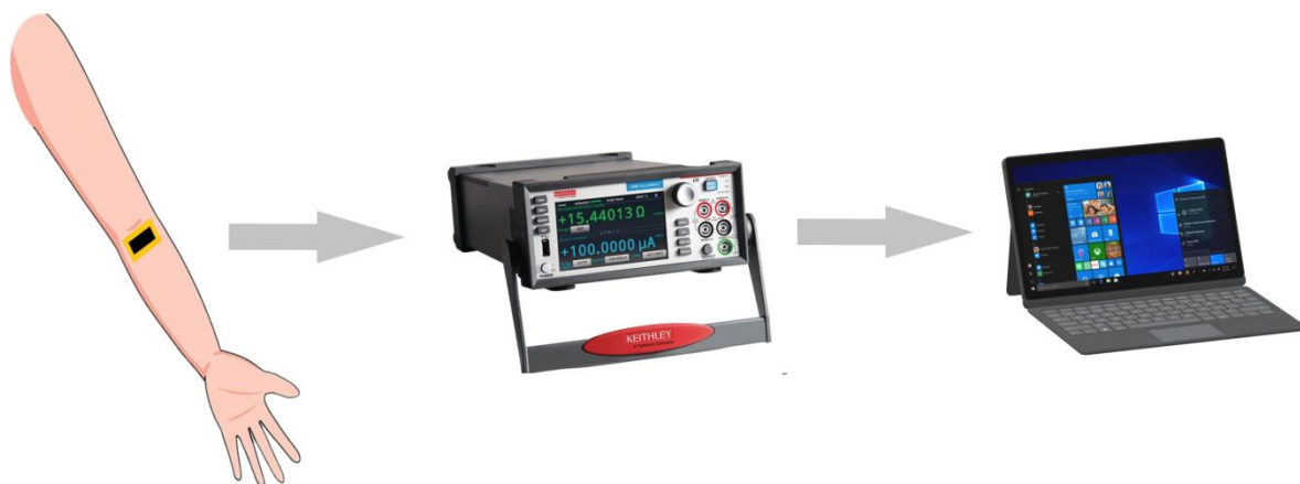
Слика 19. Шематски приказ експерименталне поставке за праћење рада срца.
