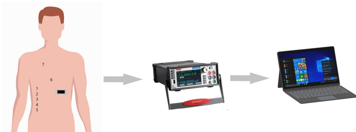
Слика 20. Шематски приказ експерименталне поставке за праћење дисања.
