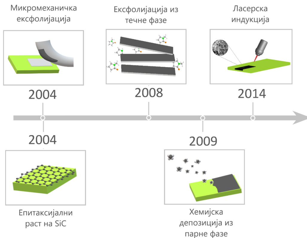
Слика 4. Илустрација најзаступљенијих метода синтезе графена смештених на временској скали у зависности од датума прве синтезе.
