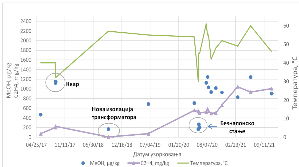
Слика 66. Промена концентрације метанола и етилена у току рада трансформатора, Случај 1
