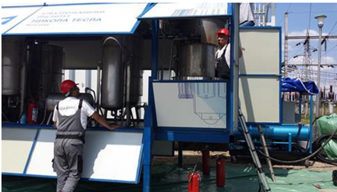
Слика 24. Индустриско постројење за ПХБ дехлоринацију и рерафинацију уља
