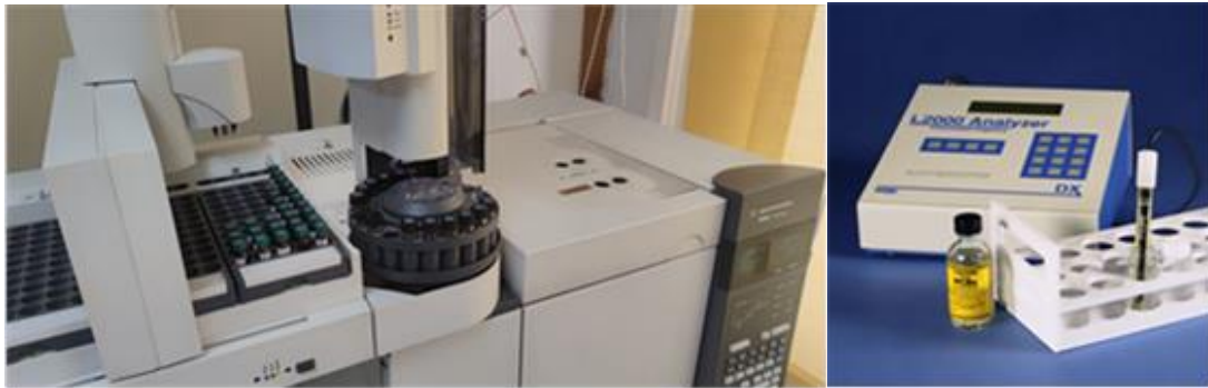
Слика 27. GC-ECD Agilent Technologies series 7890 B и Dexsil L2000DX систем
