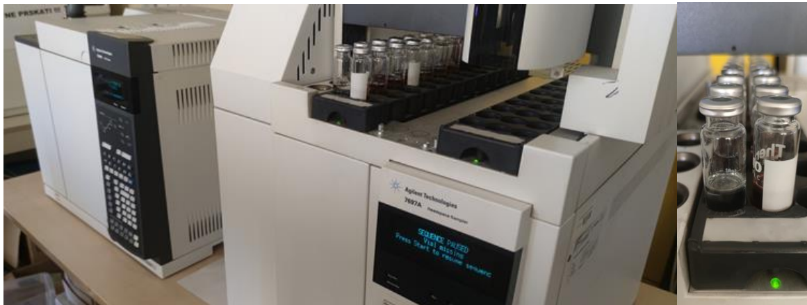
Слика 29. Гасни хроматограф, TOGA GC FID Agilent 7890B
