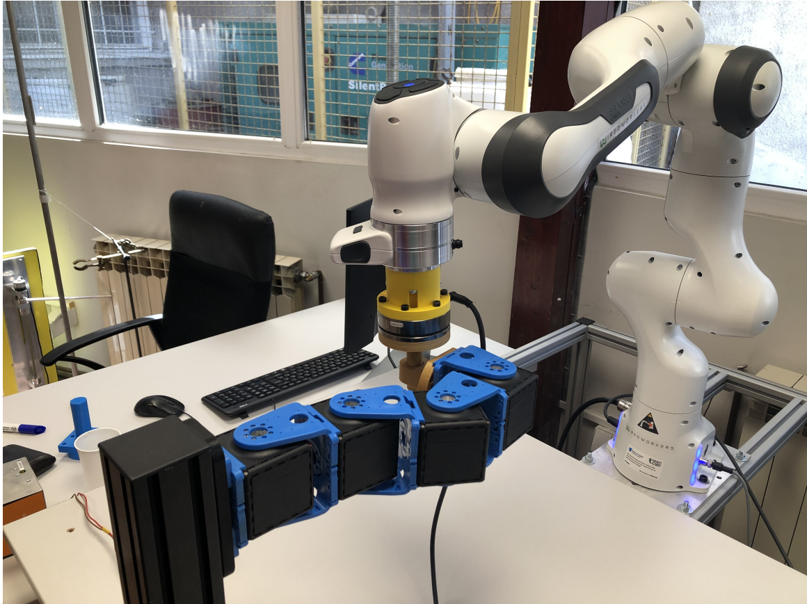
Слика 5.9: Експериментална поставка: 4 DoF планарни робота погођен QB актуаторима, Franka Robotics Panda робот, и Axia80-M8 сензор силе и момента.
