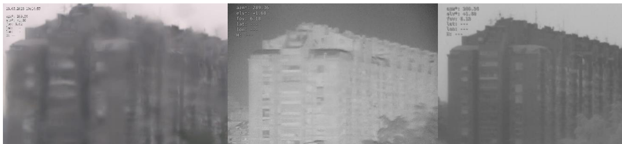
a) b) c) Slika 2.5 Zgrada u uslovima kiše: (a) vidljivi opseg, (b) MWIR, (c) SWIR.
