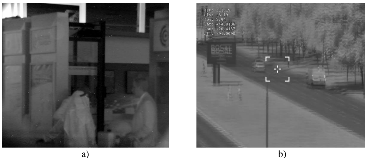
Slika 3.5 Prisutnost šuma na SWIR slici: a) usled mrtvih piksela, b) usled podrhtavanja kamere.
