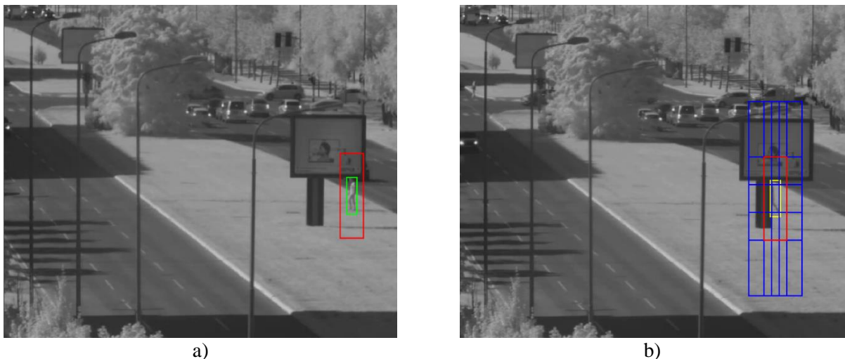
Slika 4.8 a) Praćenje objekata u regularnim uslovima primenom jednog prozora za pretragu (— objekat koji se prati, — prozor za pretragu); b) mehanizam višestrukih prozora za pretragu se aktivira nakon detekcije okluzije (— estimacija objekta, — predikcija centralnog prozora za pretragu Kalmanovim filtrom, — okolnih 8 prozora za pretragu sa međusobnim preklapanjem).
