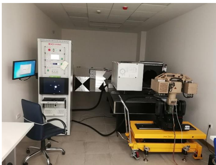
Slika 3.16 Kalibraciona procedura multisenzorskog sistema u elektrooptičkoj laboratoriji [87].
